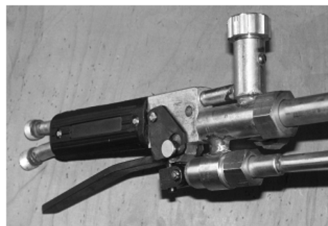
Рис. 4. Модуль 4, третья группа: рычажный клапан с параллельным расположением корпуса и разомкнутой системой рычагов
