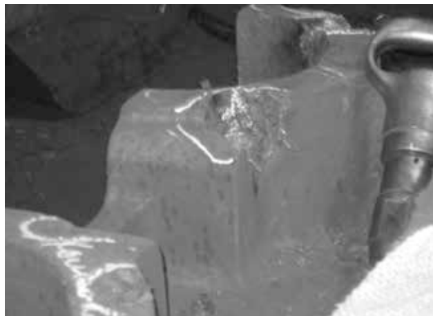
Рис. 1. Фасонная отливка готова к ремонтной сварке
