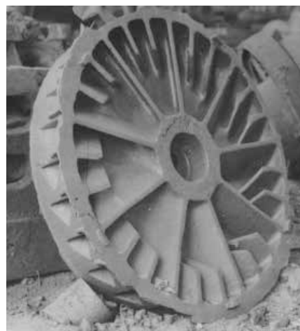
Рис. 5. Устранение недоливов в роторе насоса. Чугун ВЧ50
