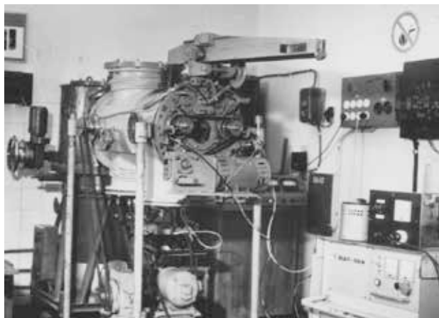
Рис. 5. Вакуумная установка с электродуговым испарителем
