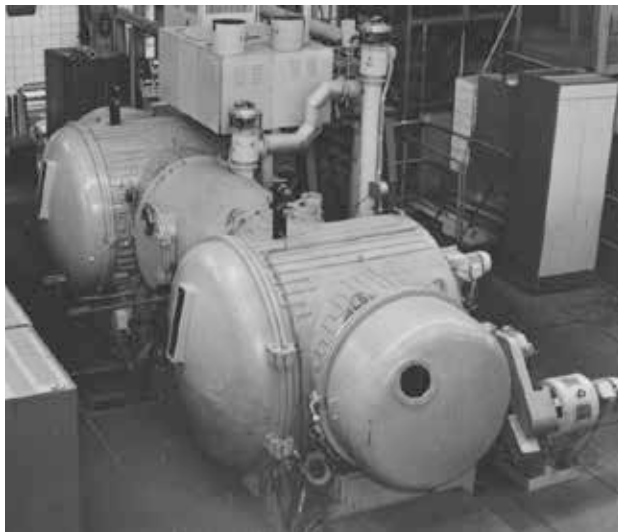
Рис. 3. Вакуумная установка для получения 5 мкм медной фольги на алюминиевом протекторе
