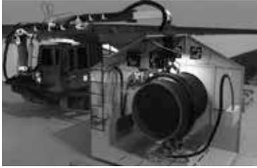
На базе технологии лазерной орбитальной сварки неповоротных кольцевых стыков труб большого диаметра с применением установки УЛСТ-1
