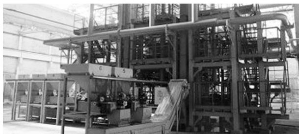
ние зоны ванны, где за счет кислородного потока происходит его горение с выделением CO<sub>2</sub> и паров воды. Далее расплав перетекает в восстановительную зону, где происходит его окончательное восстановление до чугуна.
