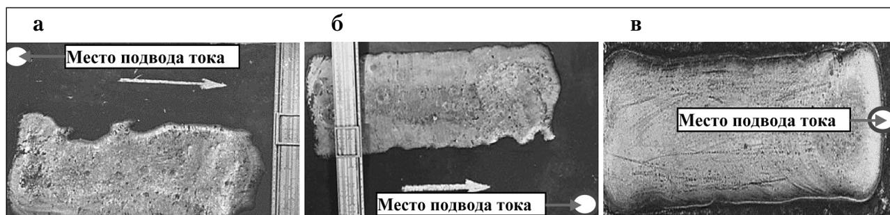
Рис. 7. Нарушение формы валика (521), наплавленного электрошлаковым методом двумя лентами шириной 120 мм, в зависимости от места подвода тока к изделию и влияния магнитного дутья: а – токоподвод с левой стороны от оси валика; б – токоподвод с правой стороны от оси валика; в – токоподвод по оси валика
