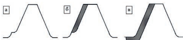
Рис. 5. Форма изношенного зуба (а) и возможные схемы его наплавки: б – восстановление первоначальных размеров зуба (схема 1); в – восстановительно-упрочняющая наплавка с заменой поврежденного материала в зоне концентрации напряжений у корня зуба (схема 2)
