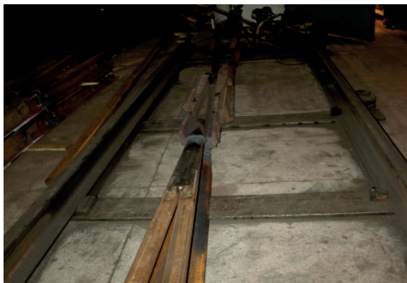
Рис. 4. Сварная крестовина железнодорожного стрелочного перевода
