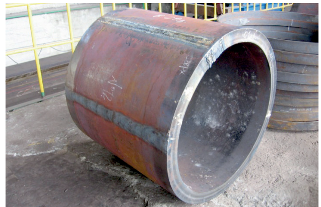
Рис. 5. Внешний вид корпуса тягового двигателя после ЭШС
