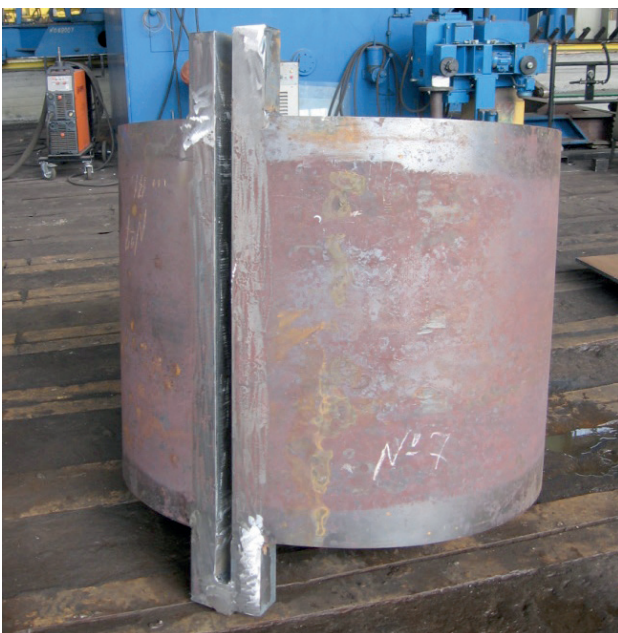
Рис. 3. Общий вид заготовки корпуса тягового электродвигателя перед сваркой
