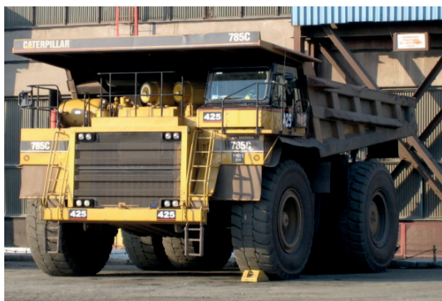
Рис. 5. Автосамосвал САТ 785С, грузоподъемность 135 т
