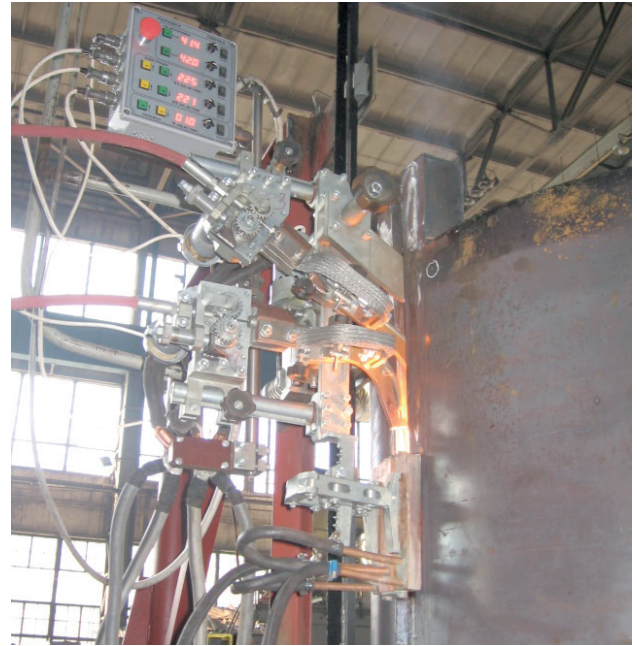
Рис. 4. Аппарат АД-381Ш в работе (заварено 2/3 шва)
