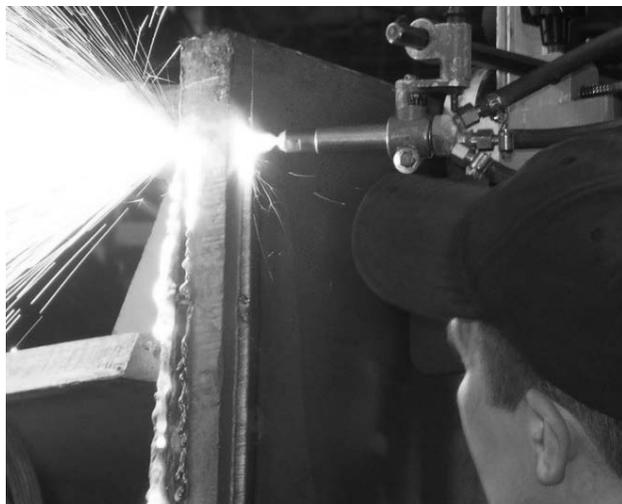
Рис. 9. Процесс кислородной резки при снятии фасок под сварку
