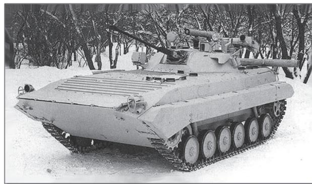
Рис. 3. Бронированная машина пехоты: сварена из алюминиевых сплавов дугowymi способами с использованием плавящихся и неплавящихся электродов
