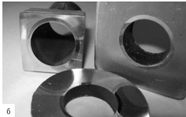
Рис. 8. Пример теплообменного блока (а) и фрагменты диффузионного соединения разнородных металлов (б)
