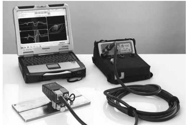
Рис. 6. Общий вид системы АCFM фирмы TSC Amigo
