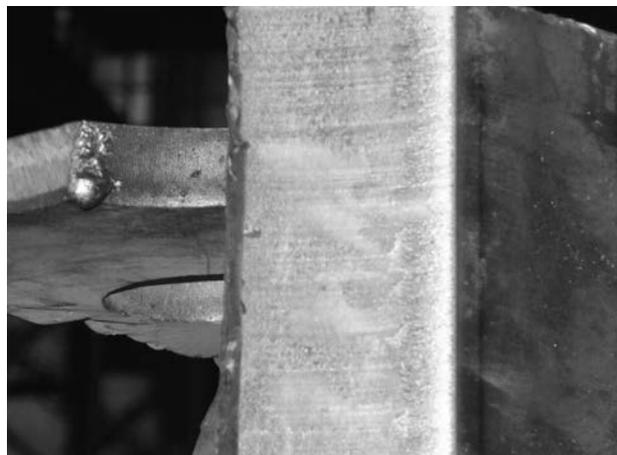
Рис. 10. Качество поверхности реза при снятии фасок под сварку на монтажной площадке при использовании машинного резака РГКМ-2-SR
