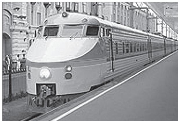
Рис. 5. Головной вагон скоростного электропоезда ЭР200, изготовленного из алюминиевых сплавов с использованием дуговой автоматизированной сварки плавящимся и вольфрамовым электродами
