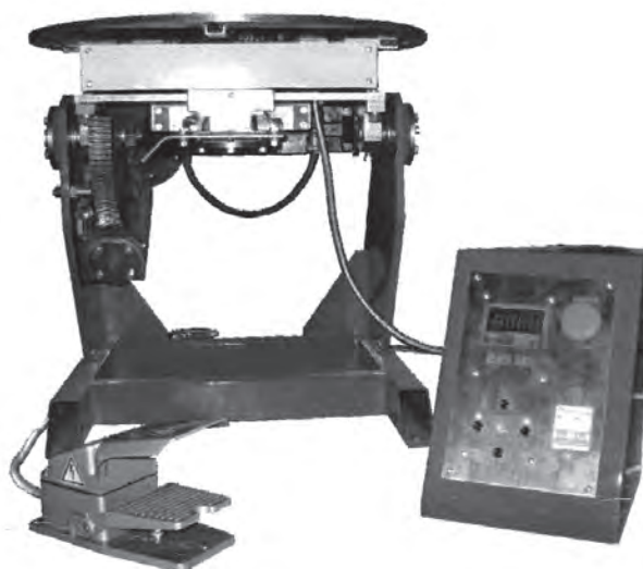
Рис. 2. Общий вид универсального вращателя грузоподъемностью 200 кг
