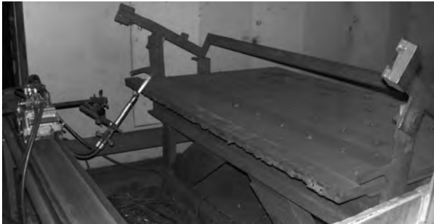
Рис. 15. Стенд для снятия фасок под сварку. Резка производится снизу - вверх под углом 60^\circ к горизонтали. Факел резака РГКМ-1-SR
