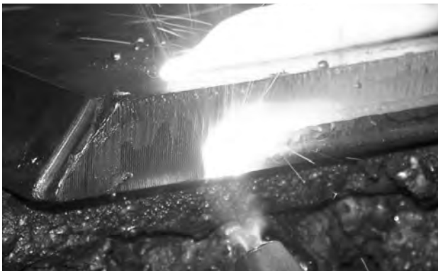
Рис. 16. Стенд для снятия фасок под сварку. Резка производится снизу - вверх под углом 60^\circ к горизонтали. Процесс резки рину, что говорит о малых размерах участка ЗТВ. Различные эпизоды синхронной резки листа ре-
