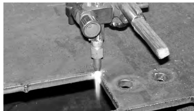
Рис. 12. Вырезка деталей из листа толщиной 16 мм
