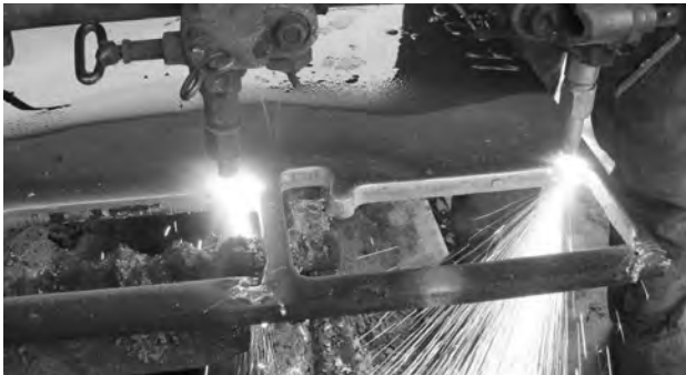
Рис. 14. Одновременная резка листа двумя резаками. РМ-2 слева, РГКМ-1-SR справа. Процесс врезания в заготовку с кромки листа
