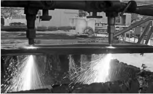
Рис. 13. Одновременная резка листа двумя резаками. РМ-2 слева, РГКМ-1-SR справа. Пробивка отверстий
