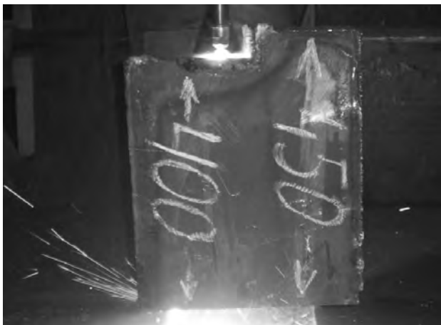
Рис. 4. Оработка режимов резки. Процесс резки ступенчатого образца толщиной 400 - 450 мм
