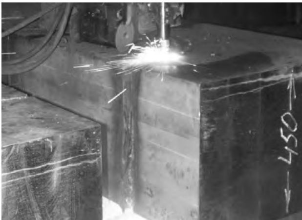
Рис. 16. Процесс вырезки полукруглых карманов на заготовке корпуса подшипника толщиной 450 мм. Начало резки
