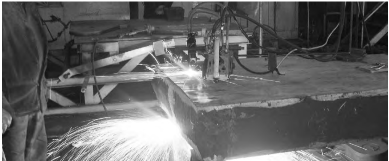
Рис. 19. Процесс вырезки отверстия на заготовке шатуна толщиной 435 мм
