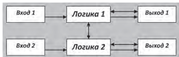
Рис. 9. Структура для категории 4 (двухканальная, с функцией самоконтроля)
