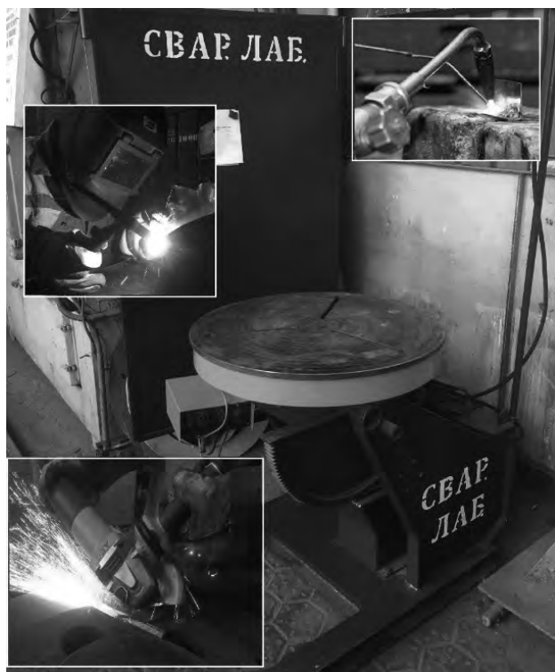
Рис. 4. Вращатель сварочный РЕМА «1000» грузоподъемностью 1 т
