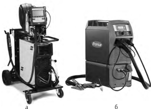
Рис. 3. Основное оборудование, используемое в лаборатории сварки ЧАО «ИСПЗ»: а - инверторный источник питания ESAB Aristo MIG 4004i Pulse; б - цифровой источник питания постоянного и переменного тока Fronius MagicWave 230i, TIG
