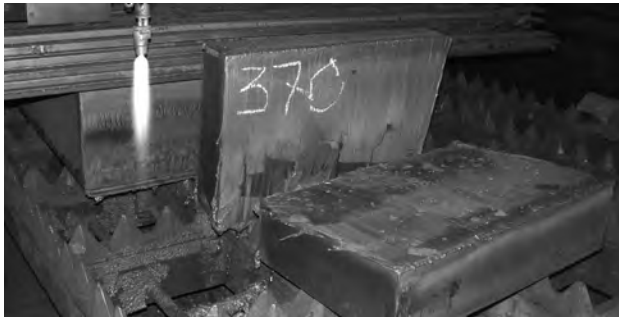
Рис. 2. Оработка режимов резки. Поверхность реза заготовки толщиной 370 мм
