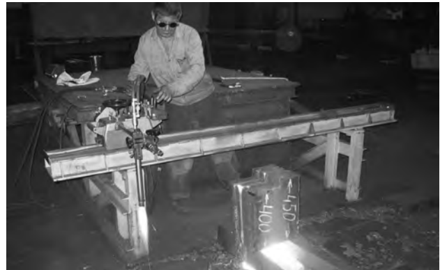
Рис. 5. Оработка режимов резки. Ступенчатый образец толщиной 400 - 450 мм после резки
