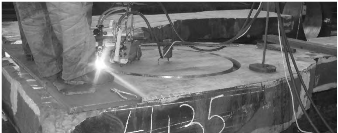
Рис. 20. Вырезка отверстия на заготовке шатуна толщиной 435 мм
