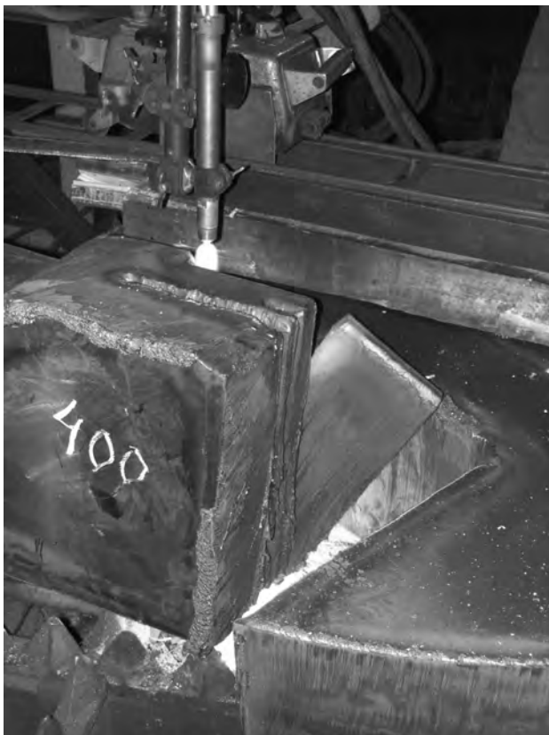
Рис. 3. Оработка режимов резки. Процесс резки и поверхность реза заготовки толщиной 400 мм
