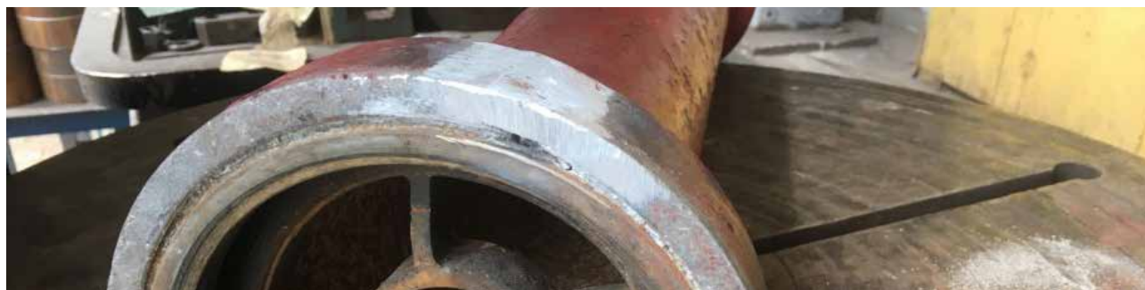
Рис. 1. Аргонодуговая сварка (TIG 141). Ремонт пожарного гидранта, пожарной службы завода. Сварка алюминий-магниевого сплава. Апрель 2019 г.
