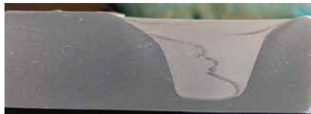
Рис. 3.2. Макрошлиф образца сплава 6082 после сварки в воде
