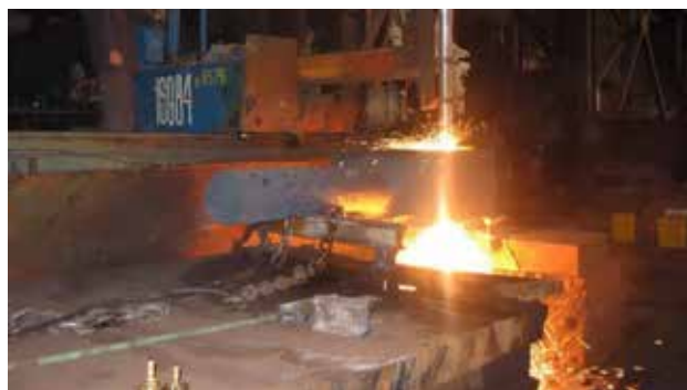
Рис. 9. Вырезка кармана на заготовке «вилка» толщиной 500 мм: врезание
