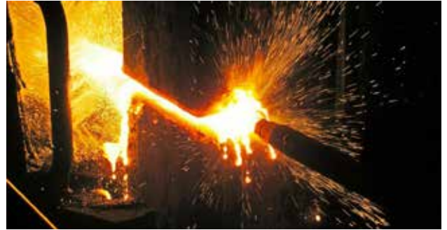
Рис. 14. Процесс резки непрерывно литого слитка сечением 400x400 мм на УНРС синхронно с вытяжкой его из кристаллизатора
