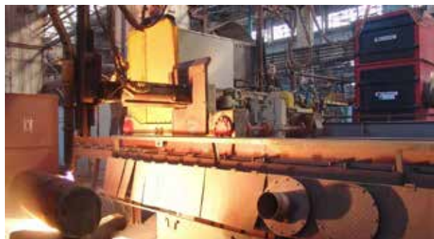
Рис. 7. Резка горячей поковки на мерные длины
