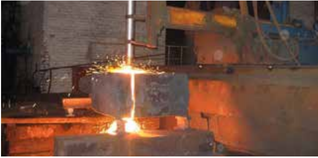
Рис. 10. Вырезка кармана на заготовке «вилка» толщиной 500 мм: процесс кислородной резки
