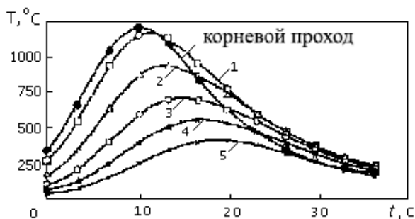
Рис. 9. Температурные циклы при многопроходной сварке трубопроводных элементов ДУ-300 первого контура многократной принудительной циркуляции
