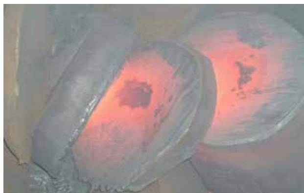
Рис. 8. Поверхность реза поковки толщиной 700 мм при температуре 650 °С
