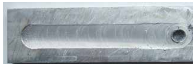
Рис. 2.2. Внешний вид образца сплава 6082 после сварки в воде
