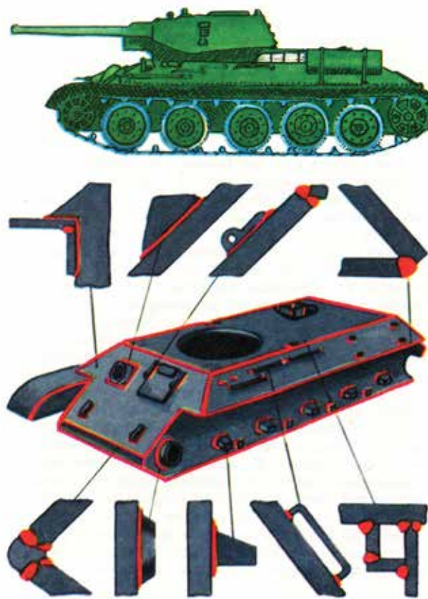
Схема некоторых сварных соединений танка Т-34
