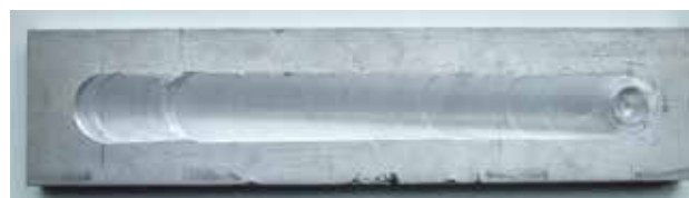
Рис. 2.1. Внешний вид образца сплава 6082 после сварки на воздухе
