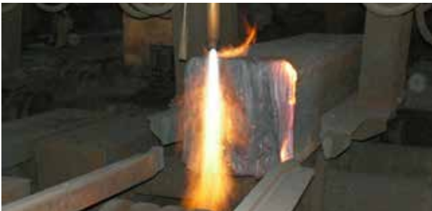
Рис. 13. Факел резака РГКМ-800 на фоне поверхности реза непрерывно литого слитка, выполненного на УНРС
