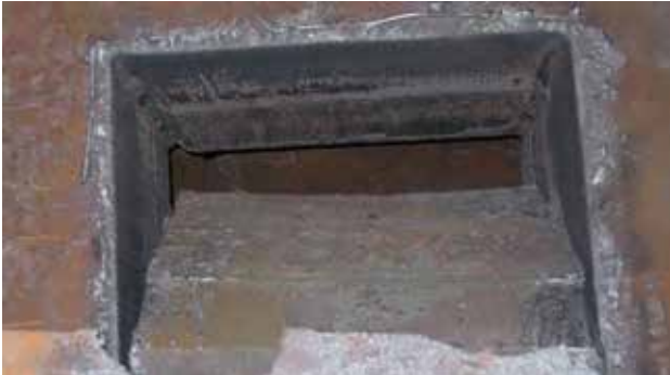
Рис. 11. Вырезанный карман на заготовке «вилка» толщиной 500 мм с кусковым отходом
