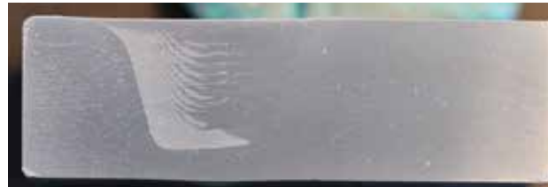
Рис. 3.1. Макрошлиф образца сплава 6082 после сварки на воздухе
