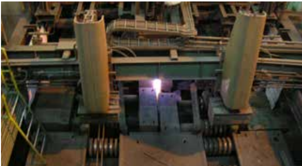
Рис. 12. Установка для кислородной резки горизонтально расположенных непрерывно литых слитков (УНРС)
