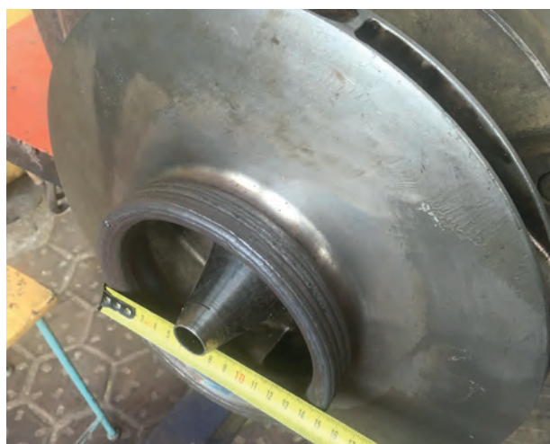
Рис. 2. Наплавка нержавеющей сталей: а) до наплавки, б) после наплавки
