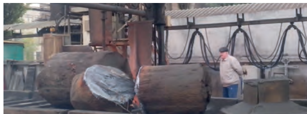
Рис. 25. Кислородная резка конца поковки круглого сечения диаметром 1400 мм с усадочной раковинкой в центре. Поверхность реза
