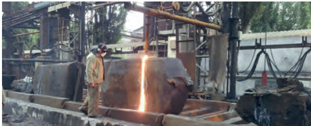
Рис. 21. Кислородная резка заготовки прямоугольного сечения толщиной 1500 мм. Процесс кислородной резки. Очевиден значительный запас мощности резака. Расслоение по линии реза в теле заготовки и пустота в месте врезания не оказали заметного влияния на процесс резки.
