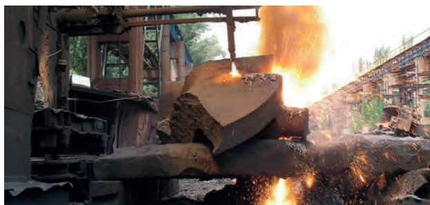
Рис. 17. Разделка осколка чугунного диска на габаритные куски
