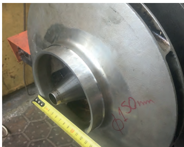
Рис. 2. Наплавка нержавеющей сталей: а) до наплавки, б) после наплавки
