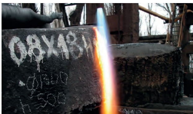
Рис. 15. Кислородная резка конца поковки диаметром 1300 мм и толщиной 750 мм из высоколегированной стали 08X18H10T. Факел резака РГКМ-2000, прогрев заготовки перед врезанием
