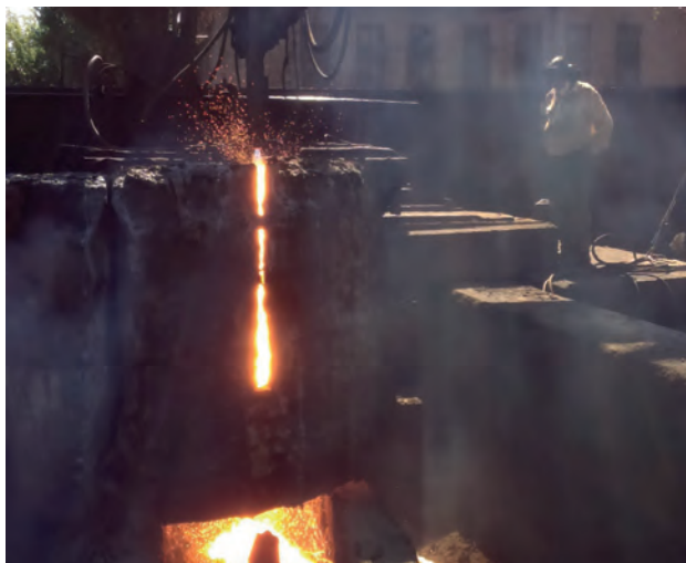
Рис. 10. Кислородная резка заготовки прямоугольного сечения толщиной 1850 мм
