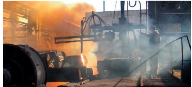
Рис. 11. Кислородная резка слитка толщиной 1200 мм на переносной машине УОПП-1
