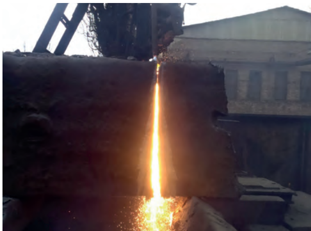
Рис. 14. Резка груза толщиной 1500 мм. Полость реза в процессе резки
