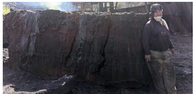
Рис. 13. Поверхность реза поковки длиной 5000 мм и высотой 1600 мм
