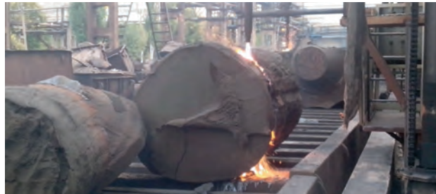
Рис. 24. Кислородная резка конца поковки круглого сечения диаметром 1400 мм с усадочной раковинкой в центре. Процесс резки
