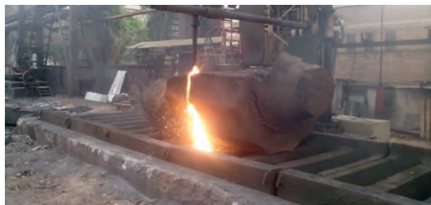
Рис. 26. Кислородная резка фрагмента крупного слитка толщиной 1300 мм
