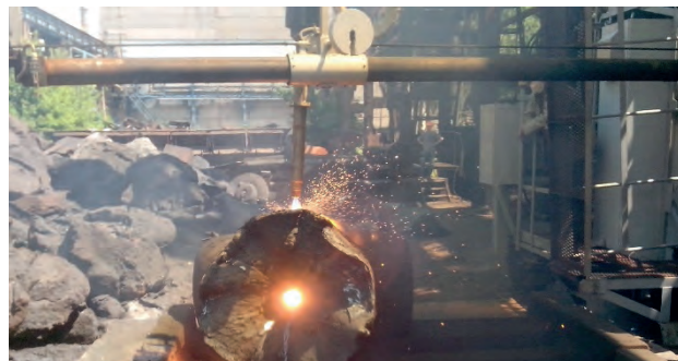
Рис. 18. Кислородная резка поковки толщиной 1200 мм с усадочной раковинной на машине УОПП-1
