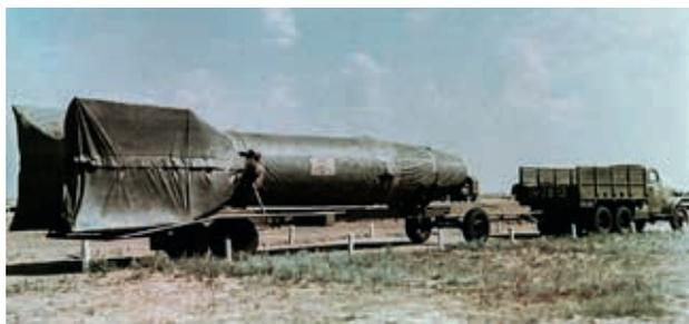
Рис. 2. Автопоезд с ракетой Р-1
