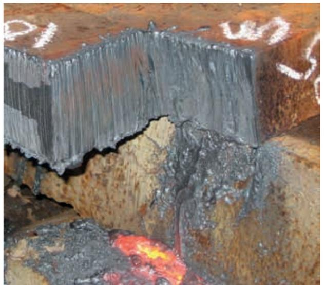
Рис. 14. Испытание резака Р1Ш-Сп на режущие свойства. Толщина заготовки – 80 мм. Материал – Сталь 20. Поверхность реза
