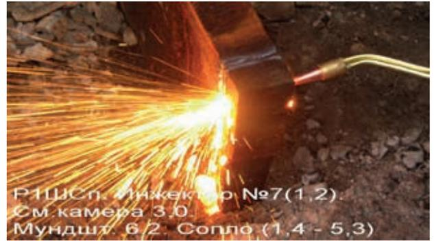
Рис. 13. Испытание резака Р1Ш-Сп на режущие свойства. Толщина заготовки – 80 мм. Материал – Сталь 20. Процесс резки
