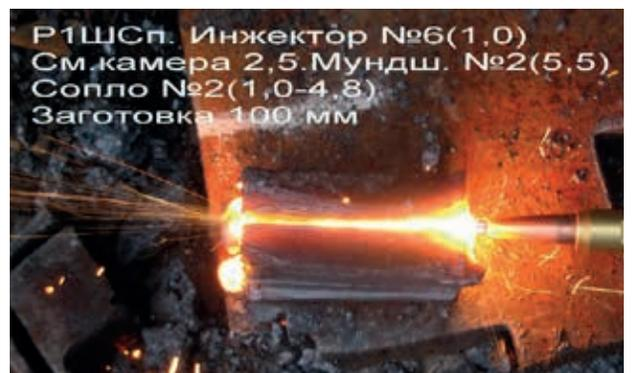
Рис. 15. Процесс резки образца толщиной 100 мм резаком Р1Ш-Сп
