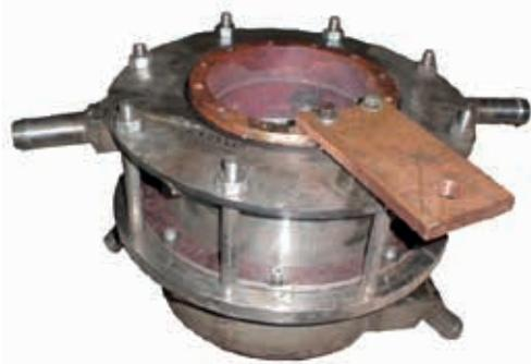
Рис. 1. Токоподводящий кристаллизатор Ø 85 мм
