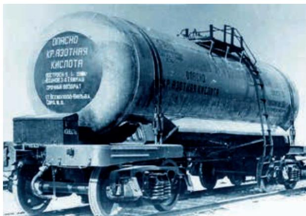
Рис. 4. Цистерна для транспортировки ракетного топлива
