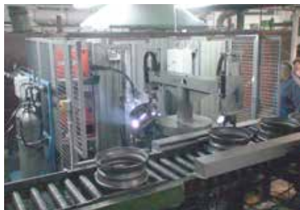
Рис. 1. Конвейер АС363 для двухдуговой МИГ-сварки обода с диском автомобильных колес
