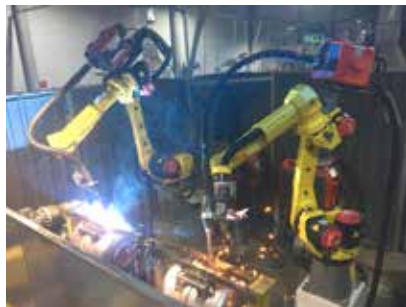
Рис. 2. Робототехнологический комплекс РК754-2 для МИГ-сварки малогабаритных изделий одновременно двумя роботами
