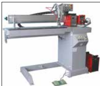
Рис. 7. Установка АС333 для ТИГ-сварки продольных швов труб
