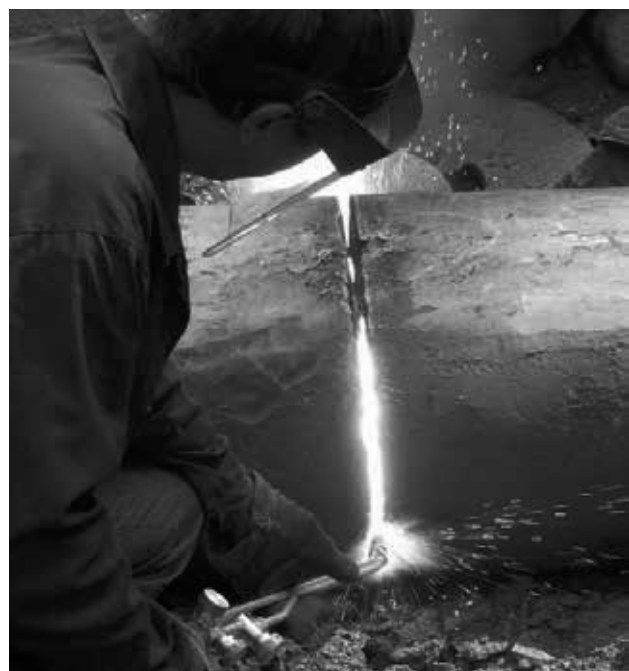
Рис. 14. НКМЗ. Копровый цех. Разделка крупного лома толщиной до 800 мм на габаритные куски – 2
