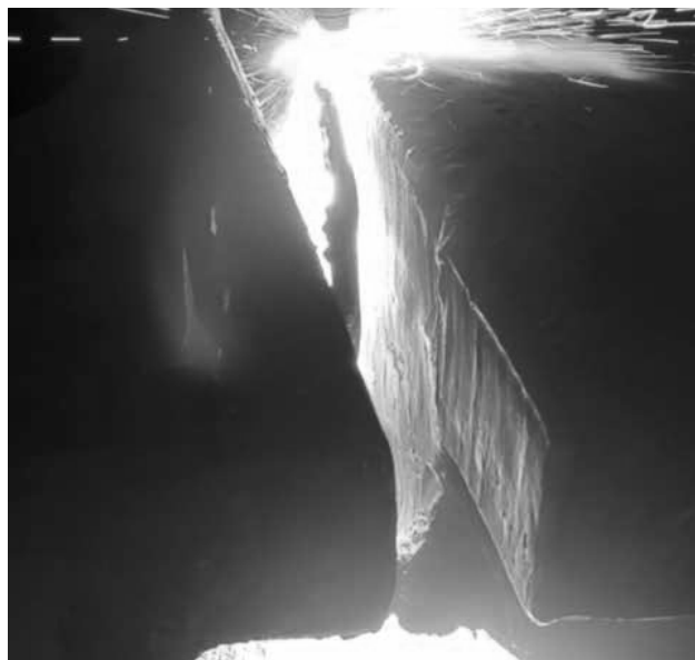
Рис. 3. Выполнение первого реза. В процессе резки видна поверхность первого реза корпуса бойка
