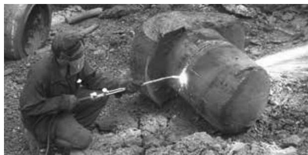
Рис. 12. НКМЗ. Копровый цех. Резка поковки толщиной 600 мм
