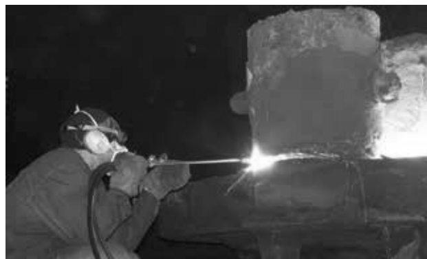
Рис. 18. НКМЗ. ФЛЦ-2. Резка прибылей крупного литья – 2
