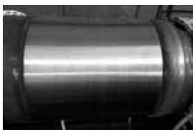
Рис. 5. Шейка баллера после механической обработки
