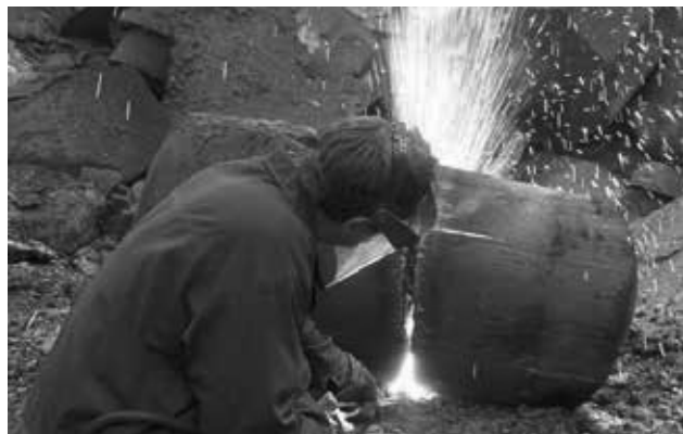
Рис. 13. НКМЗ. Копровый цех. Разделка крупного лома толщиной до 800 мм на габаритные куски – 1
