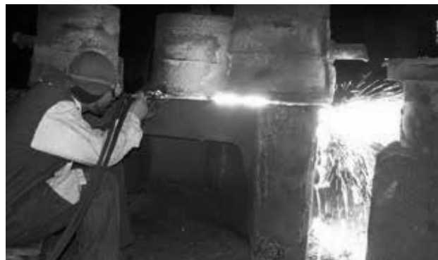
Рис. 17. НКМЗ. ФЛЦ-2. Резка прибылей крупного литья – 1
