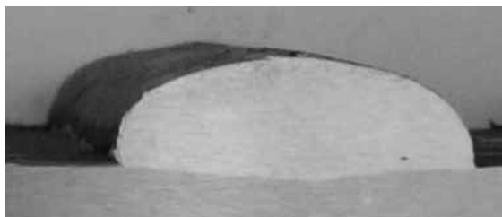
Рис. 4. Наплавка оловянной бронзы, выполненная двухэлектродным аппаратом (x2)
