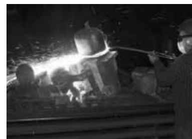
Рис. 11. НКМЗ. ФЛЦ-1. Резка прибыли толщиной 350 мм
