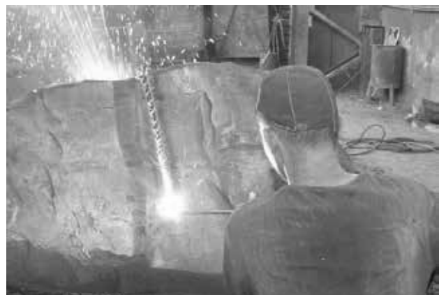
Рис. 15. НКМЗ. Копровый цех. Резка крупного отхода поковки на габаритные куски – 1
