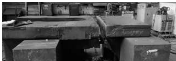
Рис. 5. Корпус бойка прессы усилием 5 000 тс, подготовленный к электрошлаковой сварке
