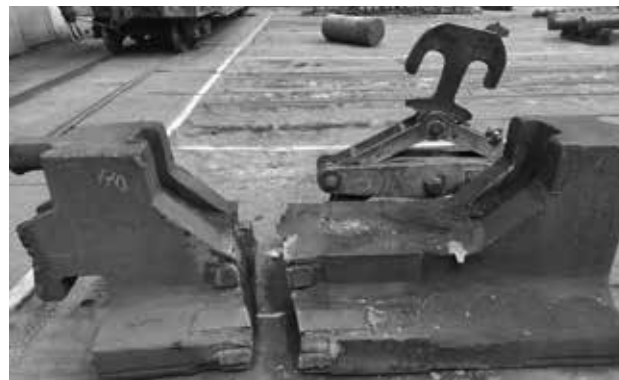
Рис. 1. Лопнувший на две части корпус бойка пресса усилием 5000 тс
