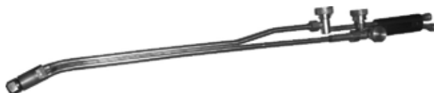
Рис. 8. Газокислородный резак ТОРН-Ш
