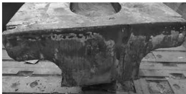
Рис. 4. Поверхность первого реза корпуса бойка металла вблизи трещины). Хорошо виден участок поверхности реза, на котором осуществлялся переход разрезаемой толщины с 200 мм на толщину 500 мм. Видно, что на этом опасном участке кислородная резка прошла плавно, без возмущений и качество поверхности реза осталось хорошим.
