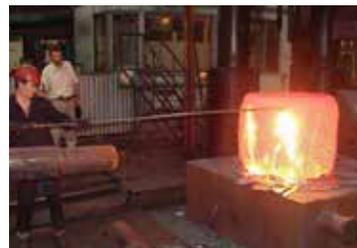
Рис. 20. Удаление поверхностных трещин на поковке перед ее прошивкой
