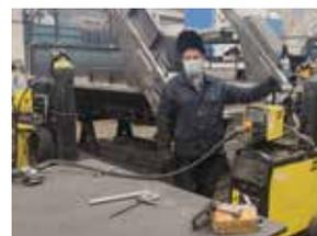
Для повышения эффективности ручной плазменной резки, на производство была закуплена установка Cutmaster 80, охватывающая рабочую зону в радиусе до 30 м, а максимальная толщина реза достигает 38 мм. Благодаря оборудованию ESAB, «РГ-Техно» удастся повысить производительность и качество выпускаемого продукта, а также сократить затраты на обработку после сварки.
