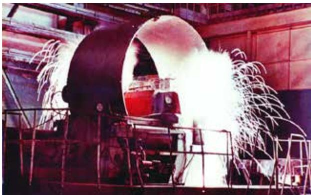
Рис. 4. Контактно-стыковая сварка оболочки топливного бака
