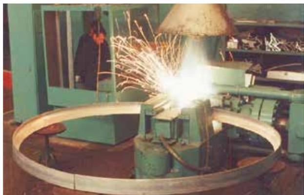
Рис. 5. Контактно-стыковая сварка шпангоута топливного бака
