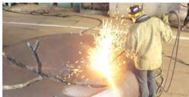
Рис. 22. Разделка трещин на холодной поковке
