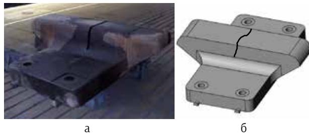
Рис. 6. Ремонт электрошлаковой сваркой выбранного механической обработкой глухого паза, полученного при удалении трещины в теле «Бойка»: а – боек с выбранной трещиной, б – трещина на рабочей поверхности бойка
