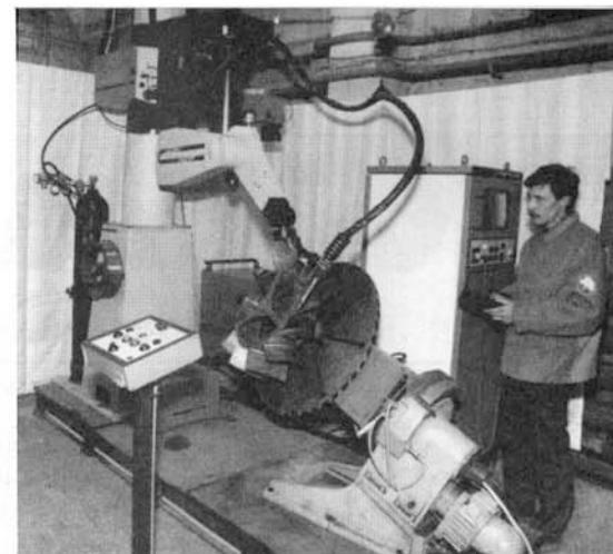
Рис. 4. РТК с одним двухкоординатным манипулятором изделия для дуговой сварки конструкций небольших габаритных размеров
