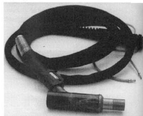
Пистолет создан на основе стандартных генераторов различных модификаций, используемых для полуавтоматической сварки в CO<sub>2</sub>, Ar или смеси газов. Сварка таким инструментом выполняется при одностороннем подходе к конструкции без существенных физических усилий. Работа сварщика после установления инструмента в зону сварки сводится к нажатию кнопки. Процесс горения и отключения дуги автоматизирован. В большинстве случаев не требуется обработка изделия или выполнение отверстий.
