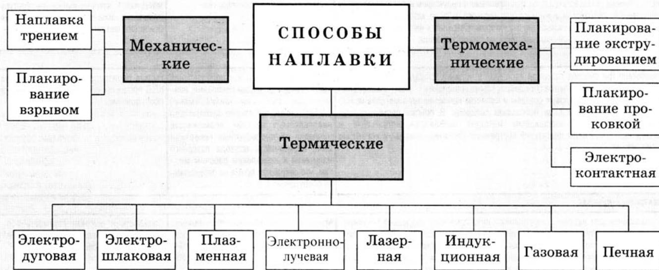
**Таблица 1. Характеристики способов наплавки**
