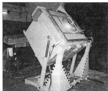
Рис. 3. Электропечь СМТ-0,3Н для плавки меди и сплавов
