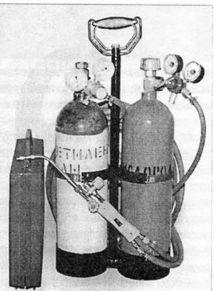
Рис. 3. Пост газосварочный ПГС-5/10-003 производства ОАО «Завод Уралтехгаз»
