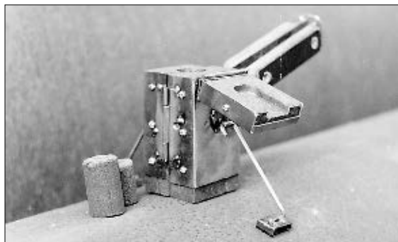
Рис. 1. Тигель-форма ТФТ для приварки выводов ЭХЗ
