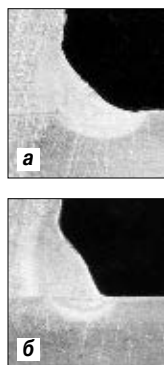
Рис. 1. Макрошлифы тавровых соединений, выполненных электродами марки АНП-10 (а) и АНП-12 (б)
