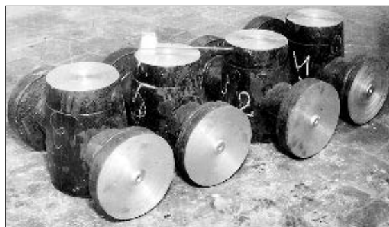
Рис. 2. Литые электрошлаковые заготовки корпусов задвижек
