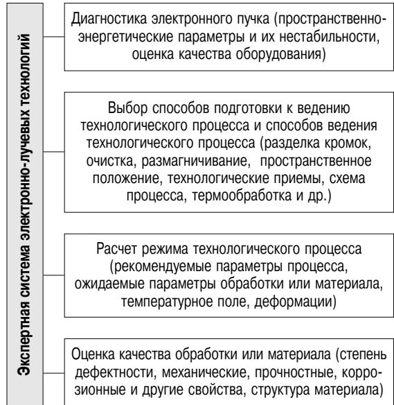
Рис. 5. Схема построения экспертной системы электронно-лучевой технологии
