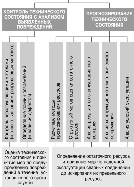
**Рис. 3. Методологический подход технического диагностирования сварных соединений паропроводов ТЭС**
