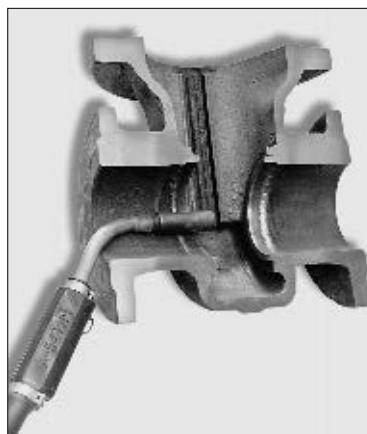
Рис. 2. Корпус задвижки из ЧШГ с вваренными уплотнительными кольцами (D y 100)
