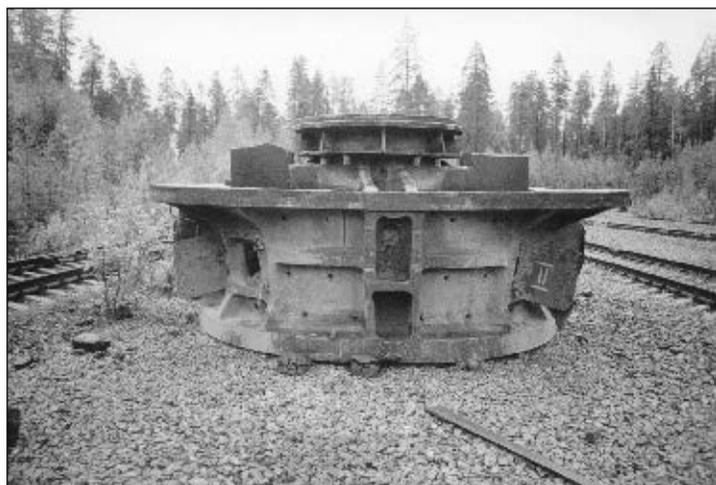
Рис. 1. Корпус станины дробилки ККД
