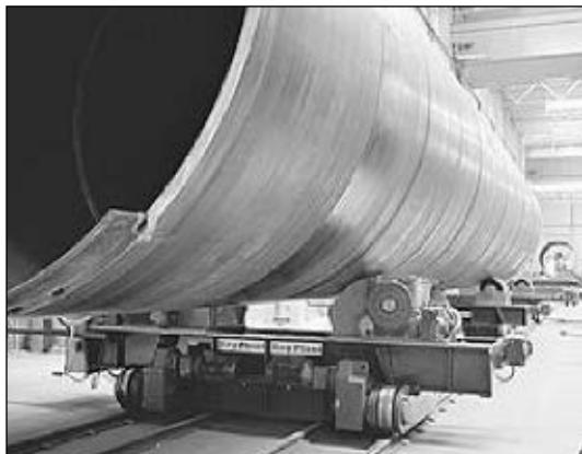
гой производственный участок. Привод и неработающие тележки связаны с мощной колесной тележкой ведущим винтом и шестеренчатым двигателем с цифровым дисплеем, показывающим положение колонн или труб различных диаметров.
