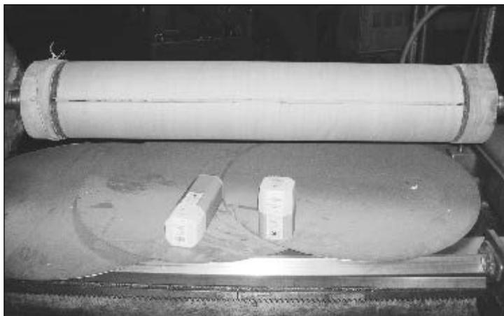
восстановлены места под подшипник вала электродвигателя мощностью 400 кВт. Для ремонта использовали порошок RotoTec 19985 с последующей токарной обработкой, рабочий слой 1,8 мм. Общее время простоя двигателя составило 24 ч.
