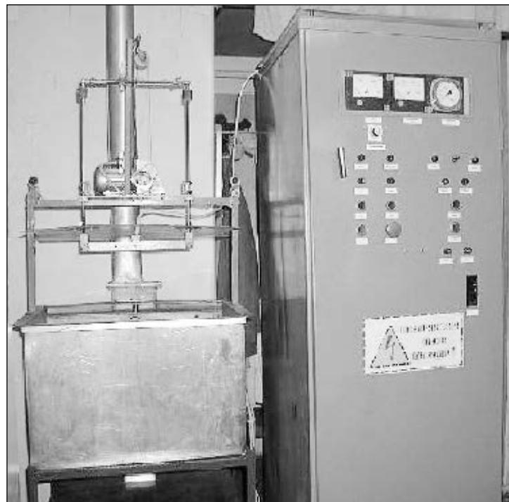
пасность процесса полировки, просты в эксплуатации и при обслуживании, к помещениям для их размещения не предъявляют жестких требований. Удаление шлама из электролита не представляет особых сложностей, поэтому электролит может служить длительное время без замены.
