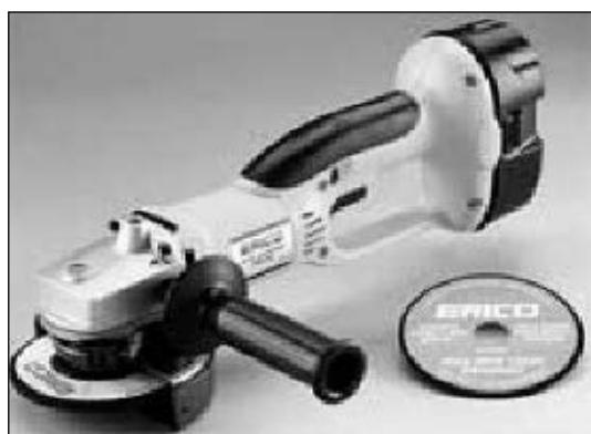
ERICO (Electric Railway Improvement Company), Огайо, США, предназначена для обслуживания рельсового стыка. Питание обеспечивают аккумуляторы напряжением 18 В. Скорость вращения диска 6500 об/мин. Этот мощный инструмент весьма компактен и эргономичен: трехпозиционная боковая рукоятка (под левую руку) позволяет контролировать процесс шлифования. Удобно пользоваться выключателем, расположенным на рукоятке для правой руки.
