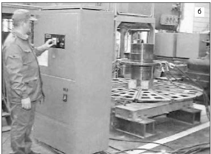
Рис. 3. Размагничивание ротора газовой турбины под электронно-лучевую сварку на НПКГ «Зоря»—«Машпроект»: а — подключение токоведущих кабелей к ротору; б — общий вид участка размагничивания
