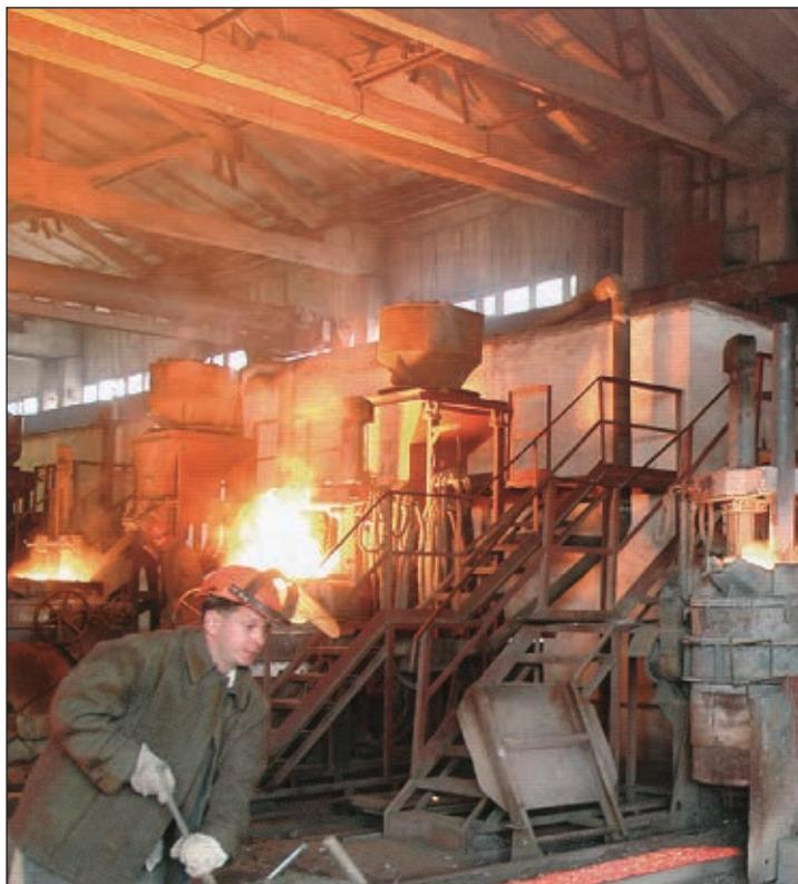
Рис. 2. Электрошлаковые плавильные тигельные установки на производственном участке предприятия
