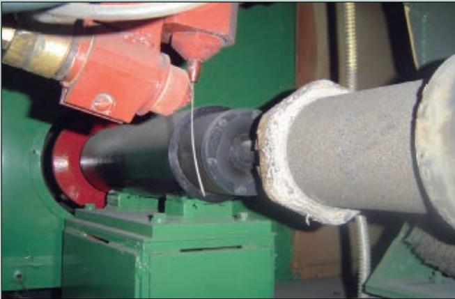
Технология напыления износостойкого покрытия основана на распылении плазменной дугой токоведущей проволоки-анода, служащей исходным материалом для образования слоя покрытия и одновременно активации напыляемого слоя специальным устройством.
