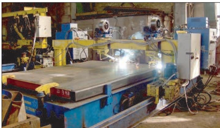
Рис. 6. Установка для сборки и сварки торцевой стены в обратном положении
