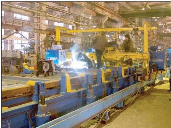
Рис. 3. Установка для сборки и автоматической сварки боковой стены в нормальном положении
