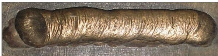
Рисунок. Формирование наплавленного металла
