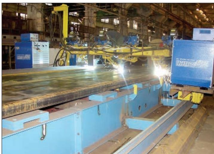
Рис. 4. Установка для сборки и автоматической сварки боковой стены в обратном положении
