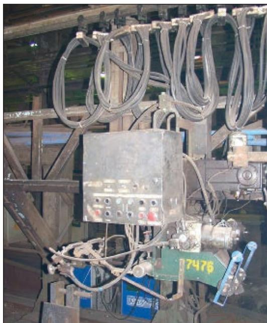
Рис. 2. Стенд для предварительного прогиба собранных балок под сварку
