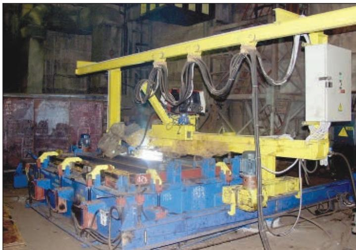
Рис. 5. Установка для сборки и сварки торцевой стены в нормальном положении
