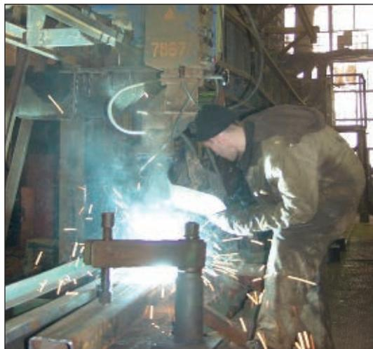
Рис. 1. Сварка на станде для сборки обвязок
