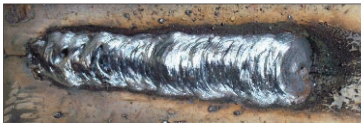
Рис. 2. Угловое соединение, выполненное в нижнем положении электродами МР-3 (проволока Ал)
