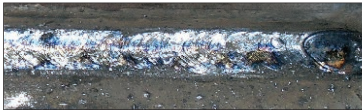
Рис. 1. Типичный вид углового соединения, выполненного в нижнем положении электродами ОЗС-4 с рутиловым покрытием (проволока Ал)
