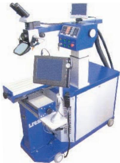
Многофункциональная автоматизированная установка LRS-150A предназначена для лазерной сварки, наплавки, прошивки отверстий, контурной резки и гравировки. Она оснащена автоматизированным двухкоординатным соплом с микроконтроллерным управлением и предназначена для выполнения широкого круга задач.
