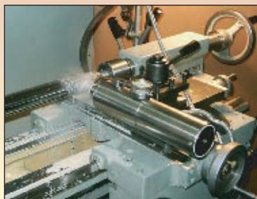
Центр производит универсальный инструмент для безабразивной ультразвуковой финишной обработки металлов, который можно устанавливать на любые токарные, строгальные, плоскошлифовальные и другие станки, предназначенные для металлообработки — комплекты БУФО.
