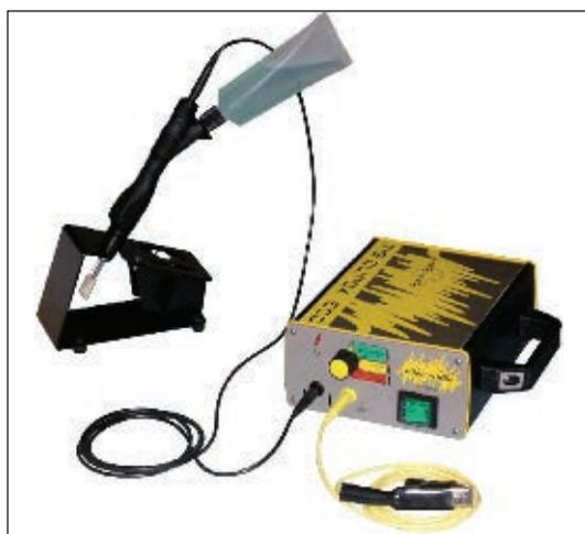
Рис. 1. Установка TIG.Clinox.eso для устранения цветов побежалости и пассивации после сварки
