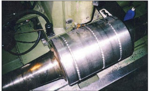
Рис. 3. Общий вид нарезки на опытном композитном валке «зуба» в полости ручьев с получением профиля калибра для прокатки арматуры № 16 DIN488 в чистой клетке мелкосортно-проволочного стана МС 320/150
