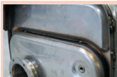
**Сварка крышки катализатора с автоматизированным обеспечением качества СМТ**
