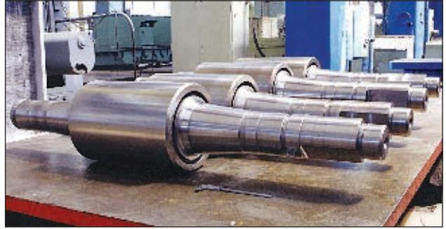
Рис. 2. Общий вид опытных композитных сортопрокатных валков (диаметр бочки валка 340 мм, длина 500 мм) с ЭШН отбеленным чугуном рабочего слоя (толщина слоя 35 мм)
