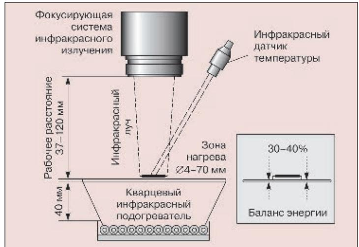
Рис. 1. Схема станции для инфракрасно-лучевой пайки
