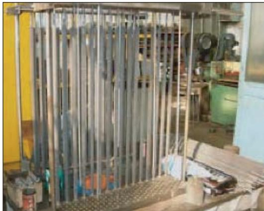
бер, перед установкой ее в отверстиях решетки надевают кольцо из припоя. В установленном ряде труб зазоры между трубой и доской заполняют наполнителем и закрепляют его раствором акриловой смолы. После завершения установки одного ряда труб приступают к установке следующего ряда. После установки всех труб в нижней труб-
