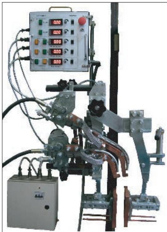
Рис. 1. Двух-электродный монтажный аппарат АД–381Ш нового поколения для электрошлаковой сварки
