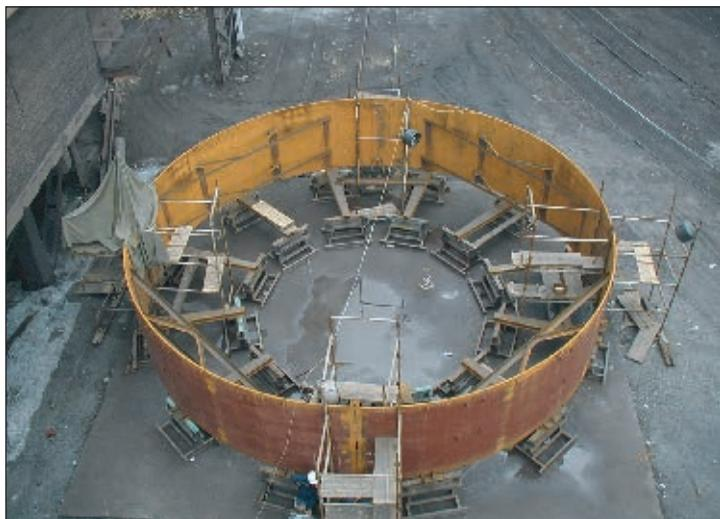
Рис. 4. Стенд для сборки и сварки обечаек корпуса доменной печи
