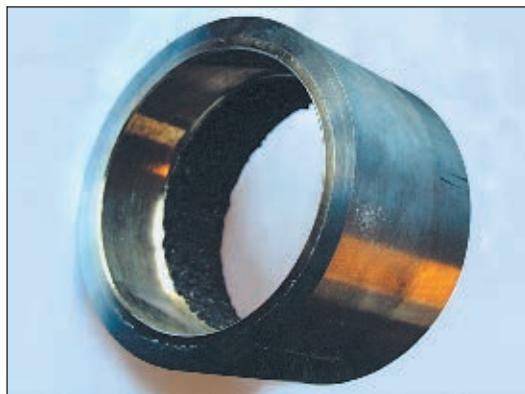
Рис. 4. Втулка ходового и опорного механизмов экскаватора
