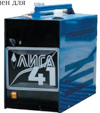
Аппарат удобен для транспортировки и перемещения с места на место во время работы. Он работает от бытовой электрической розетки, единственным расходным материалом является дистиллированная вода.
