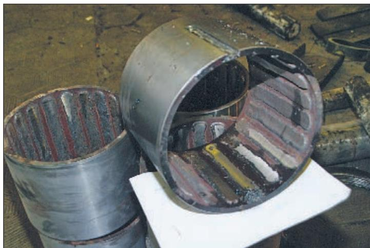
Заготовки втулок под наплавку изготавливают из стали Ст3 необходимых диаметров и с припуском до 15 мм по длине для последующей их обработки с обеих сторон, позволяющей исключить торцевые дефекты. В зависимости от внутреннего рабочего диаметра и толщины стенки втулок выполняют их предварительную расточку на толщину рабочего слоя с учетом припуска на усадку наплавляемого металла в пределах 0,5–1,0 мм и припуском на механическую обработку после наплавки до 3 мм для каждой стороны.
