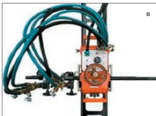
Рис. 2. Переносные газорезательные машины: а — «ДОНМЕТ 974»; б — «Смена-Эффект»; в — «Смена-2М»
