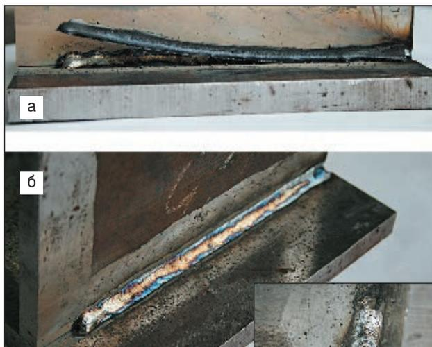
Рис. 1. Внешний вид углового шва, выполненного электродами АНО–21М: а — до удаления шлаковой корки; б — после удаления шлаковой корки
