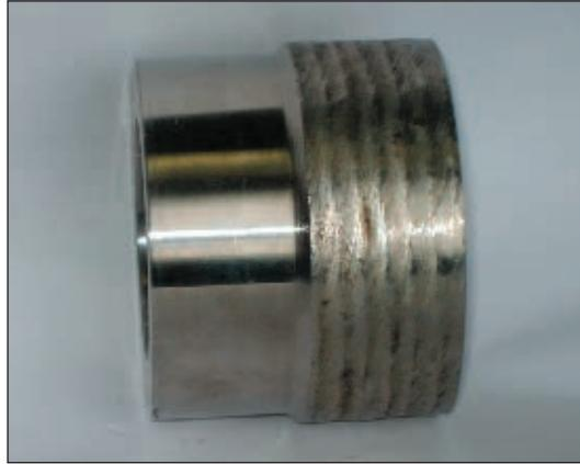
Рис. 2. Внешний вид поверхности наплавленного плунжера
