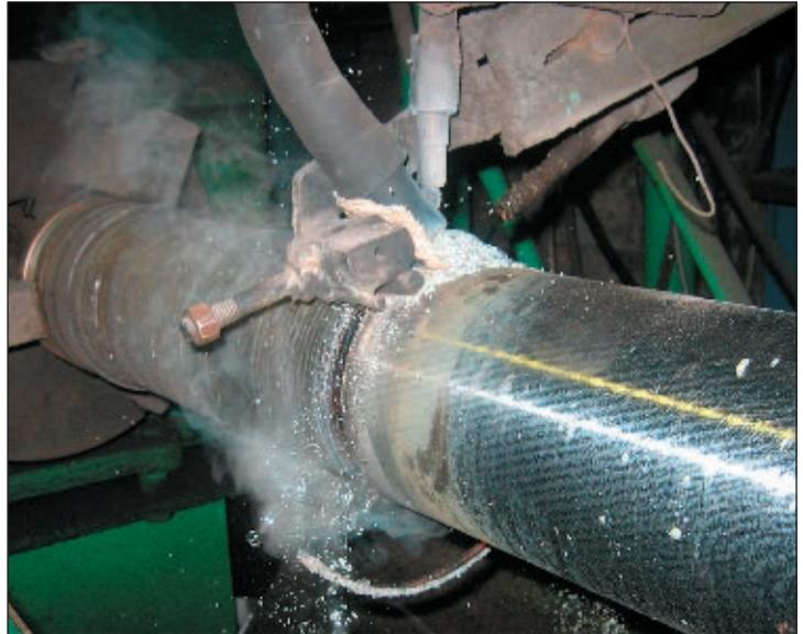
Рис. 3. Рабочий момент наплавки плунжера
