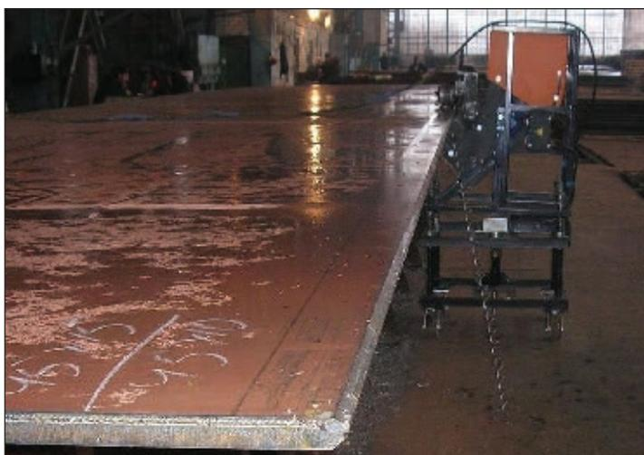
Рис. 3. Машина МКС-21У. Скальвание фаски снизу
