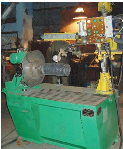
Рис. 4. Наплавка ролика МНЛЗ на установке PM-165
