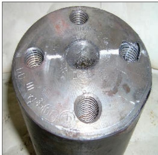
Рис. 7. Отверстие в новой (базовой) шейке оси после испытаний
