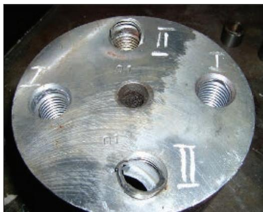
Рис. 8. Отверстие в восстановленной шейке оси после испытаний
