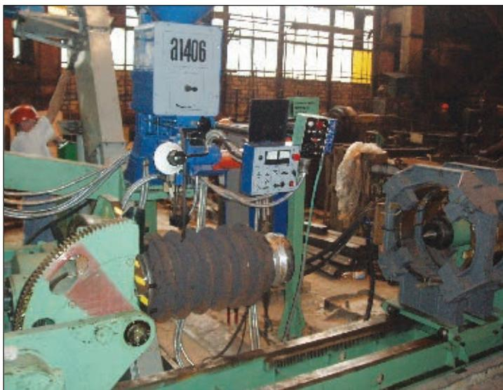
Рис. 6. Наплавка сорто-правильных роликов на установке РМ-10
