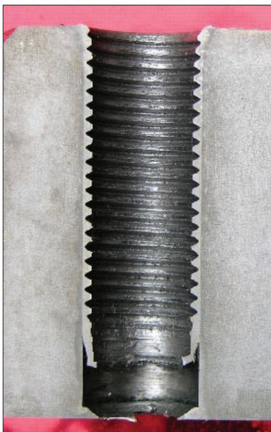
Рис. 4. Макрошлиф восстановленного резьбового отверстия
