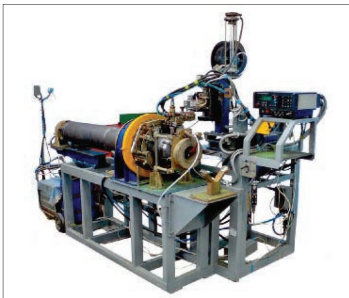
Рис. 3. Установка для сварки обечайки с днищами
