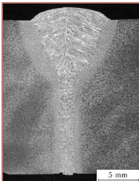
Рис. 6. Макрошлиф стыкового соединения стали толщиной 20,3 мм с Y-образной разделкой кромок плазменной резкой с нулевым зазором в притуплении. Сварка лазерно-дуговая под флюсом (лазер 20 кВт, V_{св} = 0,8 м/мин)
