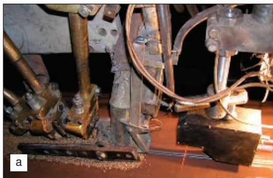
Рис. 4. Применение системы технического зрения в трубной промышленности: а — сварка труб большого диаметра под флюсом, б — аргонодуговая сварка
