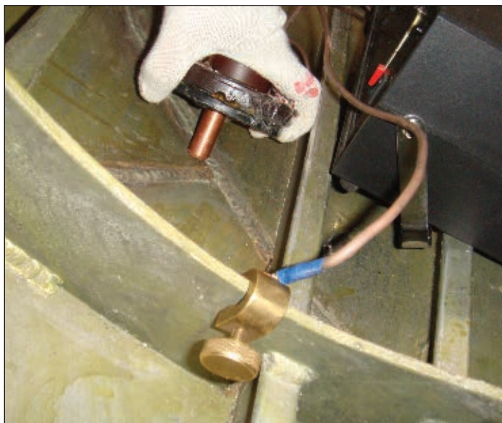
Рис. 5. Электродинамическая обработка стыковых швов усиления транца
