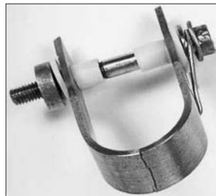
Рисунок. U-образный образец для проведения тестов на механическую коррозию
