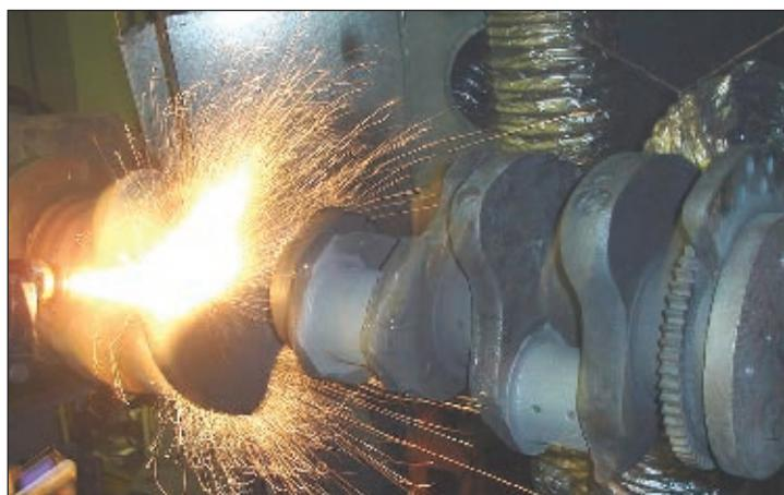
Рис. 4. Восстановление коленчатого вала двигателя «КамАЗ»
