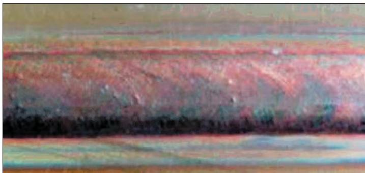
Рис. 4. Сварной шов, выполненный внахлест 2 мм 304L при 200 А и 0,9 м/мин
