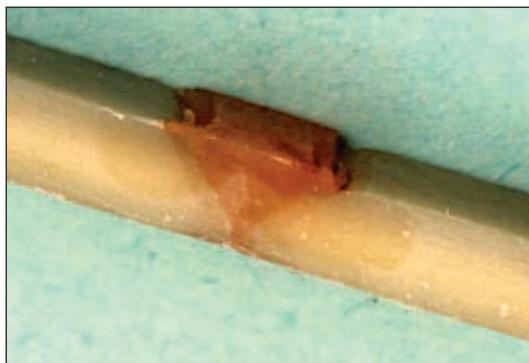
ходом полимера в вязкотекучее состояние. На этом этапе материал присадки начинает интенсивно течь и заполнять зону соединения, а мощность  $P_{эл}$ , потребляемая акустической головкой, стабилизируется независимо от режима УЗС. При этом прочность сварного соединения составляет около 50% прочности основного материала.
