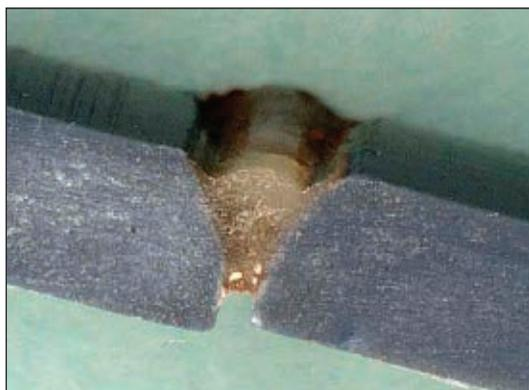
Рис. 1. Сварное соединение, полученное при сварке полимерных листов нагретым газом с присадочным прутом
