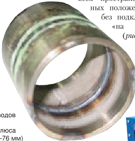
Рис. 1. Неповоротный стык трубы диаметром 76х4,5 мм из стали 12Х18Н10Т, выполненный за один проход орбитальной АТИГ-сваркой
