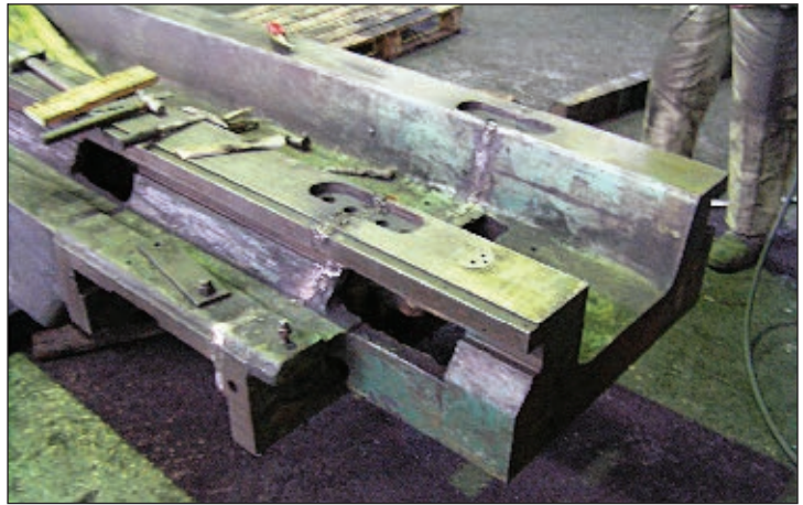
Рис. 3. Общий вид траверсы токарно-карусельного станка модели 1Л532 после ремонта
