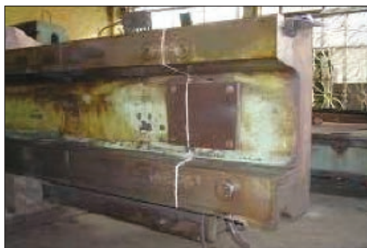
Рис. 1. Чугунная траверса токарно-карусельного станка 1Л532
