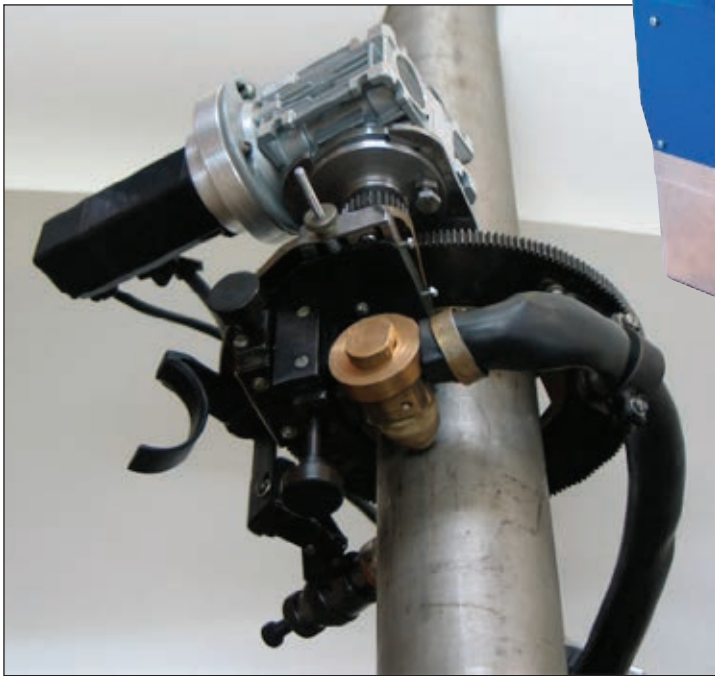
Рис. 2. Аппарат для орбитальной сварки трубопроводов с применением активирующего флюса (диаметр труб 57–76 мм)
