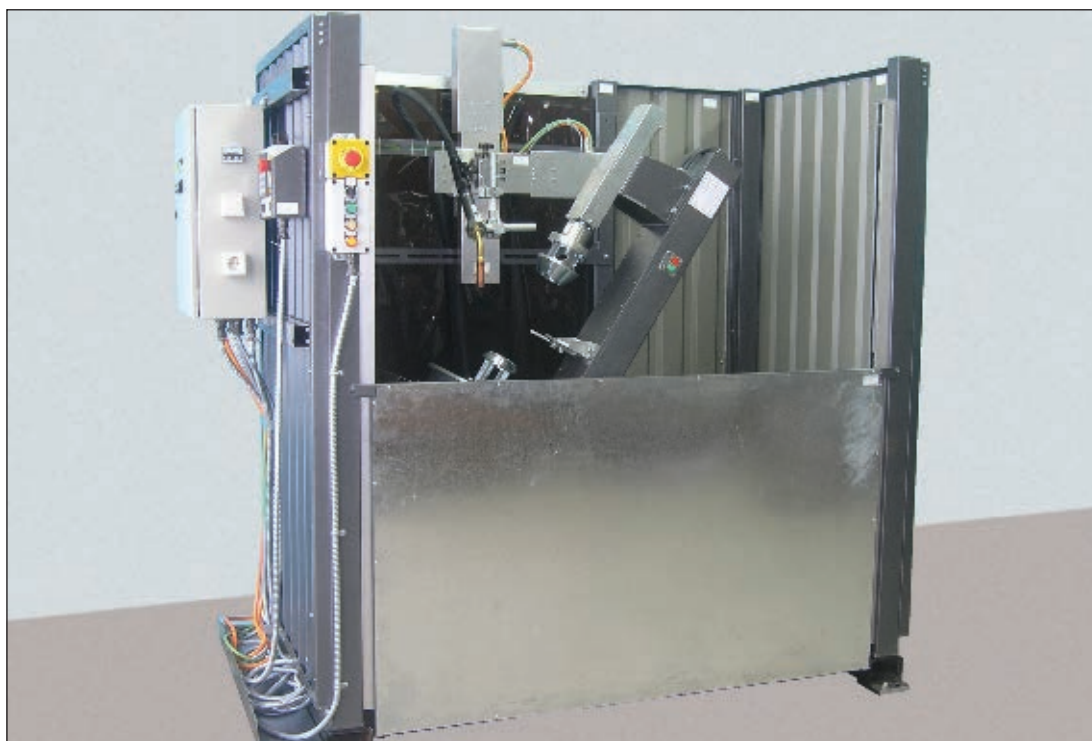
Рисунок. Установка АС349-Б для автоматической дуговой МИГ/МАГ-сварки поворотных кольцевых многослойных швов
