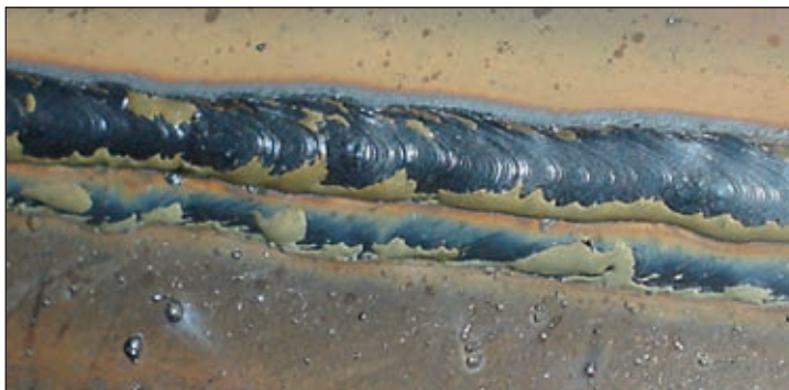
Рис. 1. Внешний вид шва, полученного дуговой сваркой в \text{CO}_2
