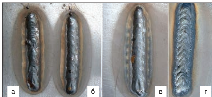
Рис. 2. Внешний вид швов, полученных дуговой наплавкой стального листа в различной защитной газовой среде: а — \text{CO}_2 ; б — 82% \text{Ar} + 18% \text{CO}_2 ; в — 93% \text{Ar} + 5% \text{CO}_2 + 2% \text{O}_2 ; г — \text{Ar}
