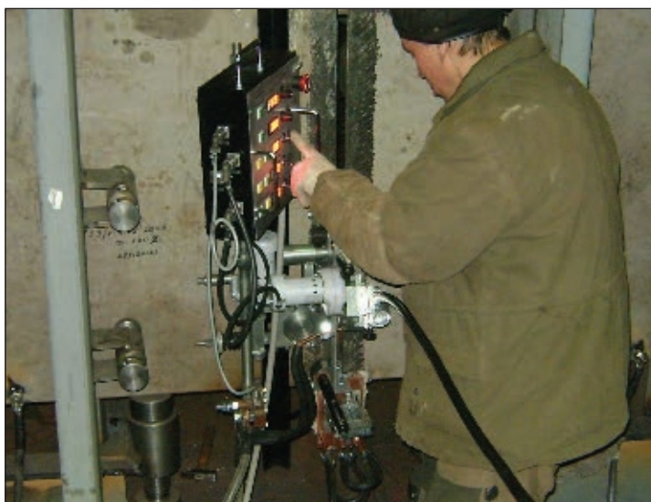
Рис. 2. Электрошлаковая сварка полотнищ из стали 08Х18Н10Т толщиной 40 мм аппаратом АД-381Ш
