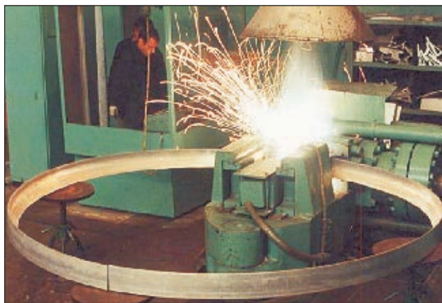
Контактная стыковая сварка шпангоута
