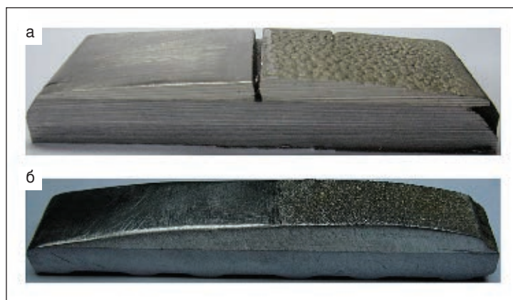
Рис. 4. Вид АДМ-покрытия толщиной 5 мм: а — баббит Б88 из проволоки диаметром 1,6 мм; б — баббит Б83 из проволоки диаметром 3 мм. Справа — после напыления, слева — после обработки
