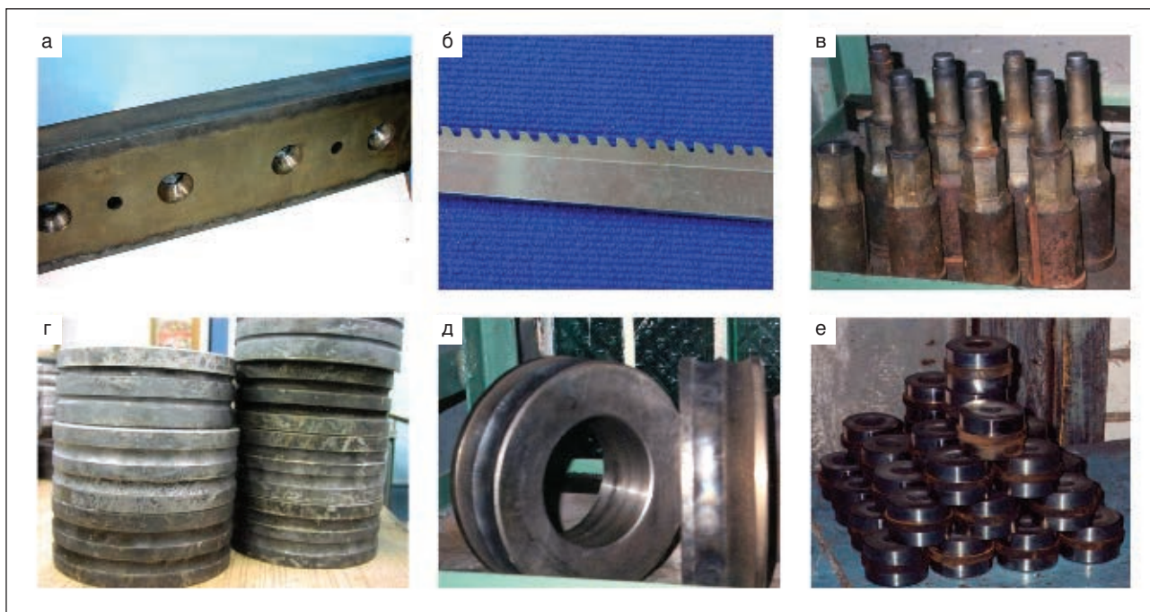
Рис. 6. Вид упрочненного инструмента: а — металло-режущий нож; б — шлицевая протяжка; в — деформирующий пуансон; г — твердосплавный прокатный ролик; д — чугунный прокатный ролик; е — деформирующие матрицы
