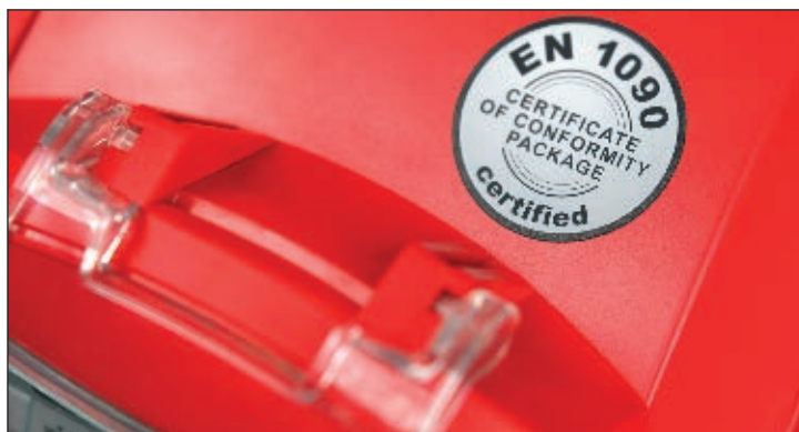
Специальная наклейка на сварочном аппарате TransSteel указывает на соответствие оборудования требованиям стандарта EN 1090
