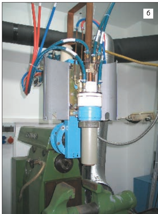
Рис. 2. Модернизация фрезерного станка для импульсно-плазменного упрочнения инструмента: а — схема фрезерного станка; б — внешний вид модернизированного станка
