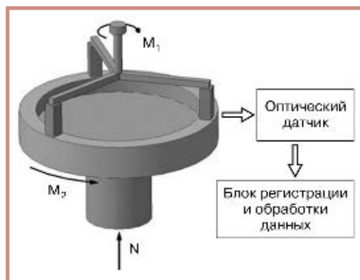
Рис. 1. Принципиальная схема трибологических испытаний
