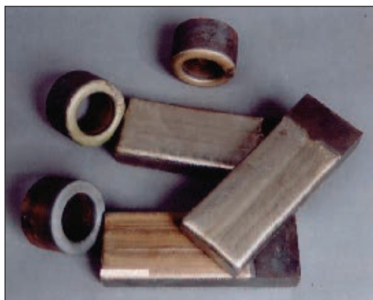
Рис. 4. Седла и шиберы фонтанных задвижек DN 50, наплавленные плазменно-порошковым способом
