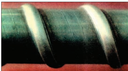
Рис. 5. Фрагмент наплавлен- ного червяка экструдера
