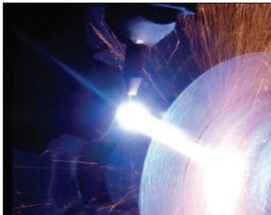
Рис. 3. Плазменно-дуговая металлизация шейки оси
