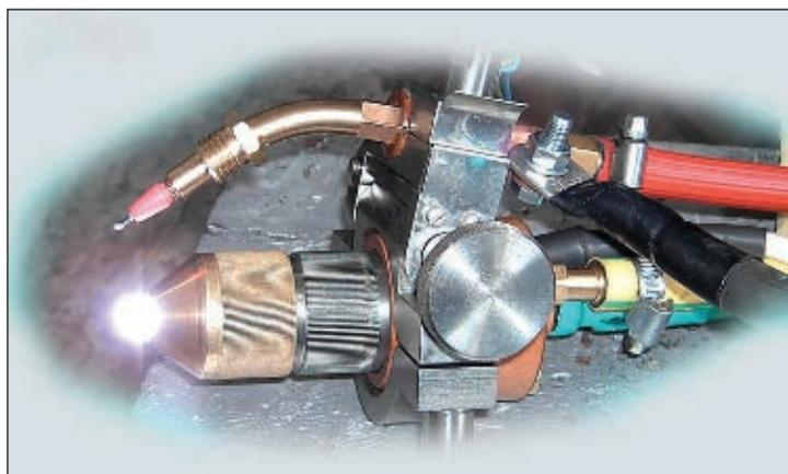
Рис. 2. Плазмотрон плазменной установки полуавтоматической линии PLAZER 30PL-W
