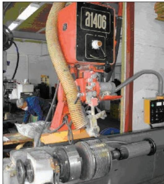
Рис. 3. Установка наплавки валков центрифуг
