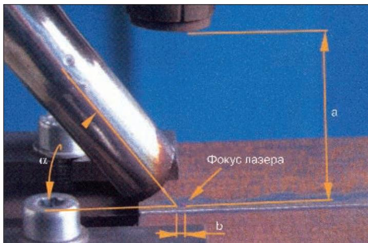
Рис. 2. Взаимное расположение лазерной головки и сварочной дуги при гибридной сварке: а — рабочее расстояние лазерной головки (50 мм); б — смещение лазерного луча (2 мм);  $\alpha$  — угол наклона MAG сопла ( $\alpha=55^\circ$ )
