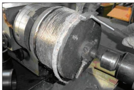
Рис. 4. Рабочий момент наплавки вала
