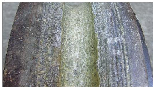
Рис. 2. Характерный износ поверхности третьего вала
