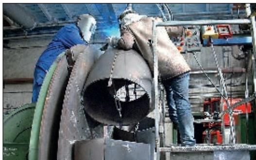
Эксплуатация автоматизированной системы тандем-сварки TimeTwin на производственных мощностях компании Uhlig Rohrbogen
