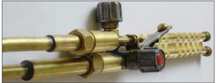
Рис. 2. Резак для выплавки дефектов на поковках РПКЗ
