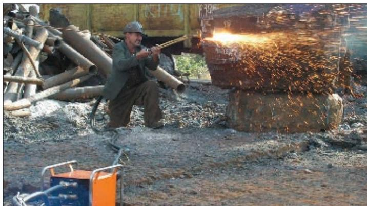
Рис. 7. Резка стального «козла» полуавтоматом УРВД. Резак РПКЗ-02 с наконечником для резки концов поковок и удаления наплывов
