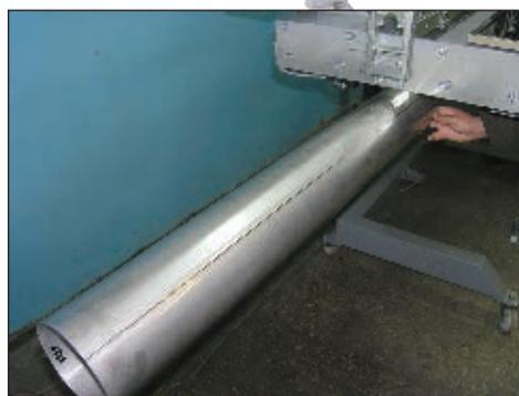
Рис. 2. Внешний вид сварного шва
