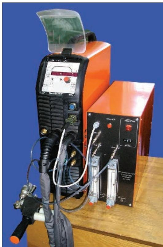
Рис. 1. Внешний вид установки МПН-004 для микроплазменного напыления
