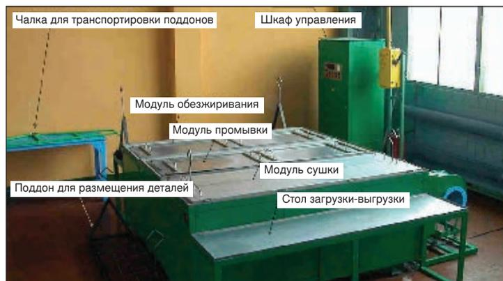
Рис. 7. Комплекс оборудования для обезжиривания деталей
