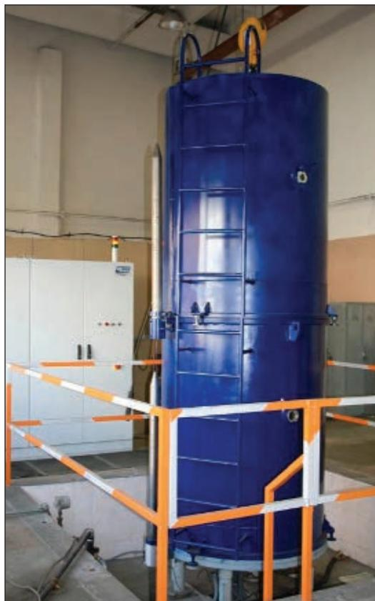
Рис. 1. Установка УА-63-950/3000 с изменяемой геометрией рабочей камеры
