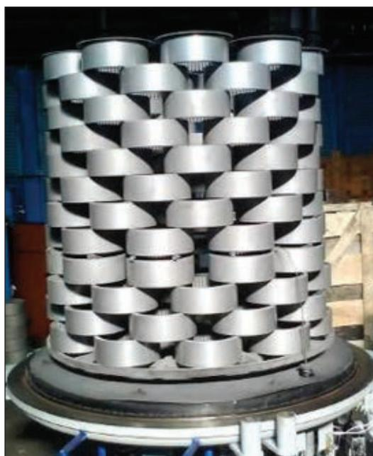
Рис. 3. Шестерни из стали 25ХГТ, размещенные в камере установки
