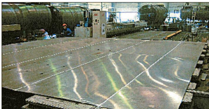
Рис. 5. Карта, полученная сваркой трением с перемешиванием из проката 7000x1500 мм
