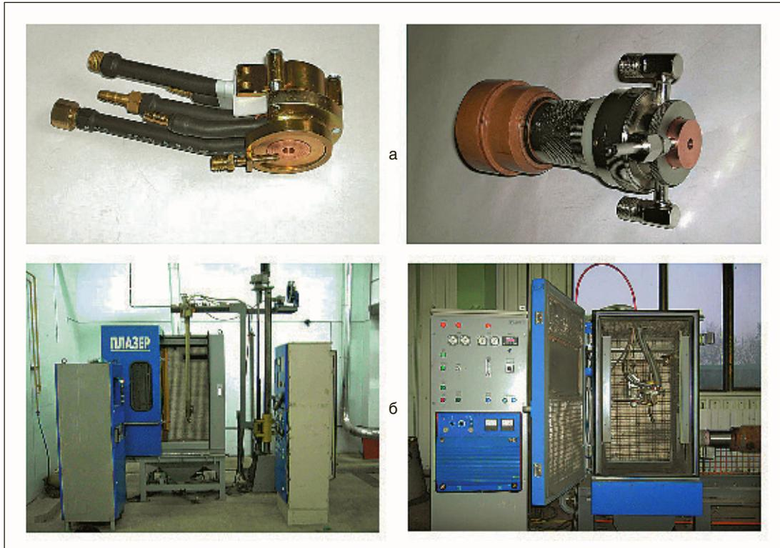
Рис. 2. Плазматроны для внутреннего и наружного напыления (а) в установках плазменного напыления «ТОПАС 40» в составе полуавтоматов для напыления ООО «Оберт» (б)
