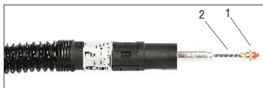
3. Новый разъем горелки FSC: 1 — дюза для фиксации подающего канала; 2 — направляющий канал
