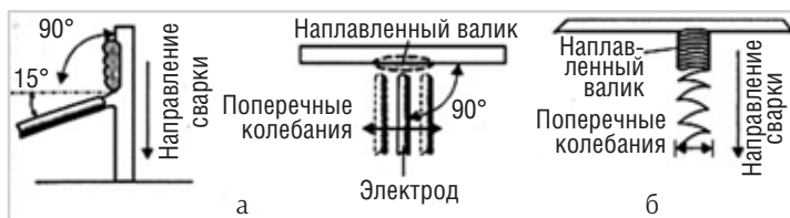
Рис. 7. Положение электрода при наплавке валиков в вертикальном положении сверху вниз с поперечными колебаниями электрода (а) и траектория движения электрода (б)
