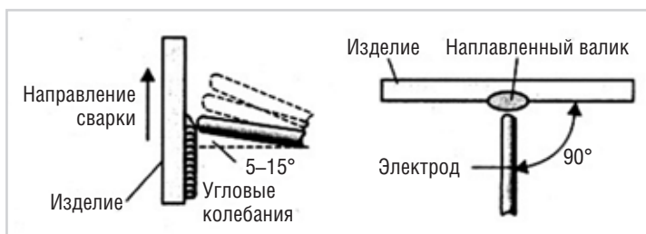
Рис. 4. Положение электрода при наплавке узких валиков без поперечных колебаний электрода в вертикальном положении снизу вверх
