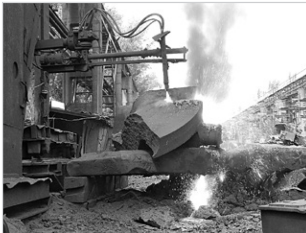
Рис. 4. Экспериментальная резка чугунного корпуса на металлолом
