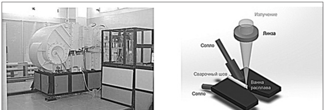
Рис. 1. АЛТК «Сибирь-1» и технологическая схема термообработки
