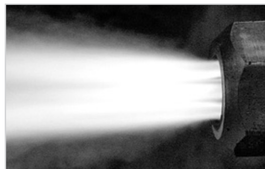
Рис. 2. Факел резака РГКМ-5 с включенными дополнительными режущими струями и основной режущей струей
