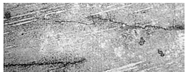
Рис 4. Вид трещин в ЗТВ, x500
