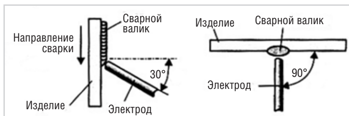
Рис. 5. Положение электрода при наплавке узких валиков без поперечных колебаний электрода в вертикальном положении сверху вниз.
