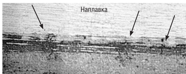
Рис 3. Цепочка дефектов в ЗТВ
