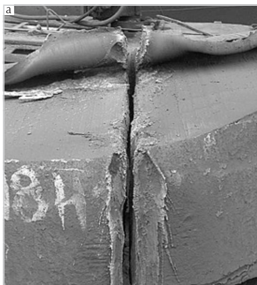
Рис. 6. Полость реза со стороны начала резки (а), и со стороны окончания резки (б). Диаметр прибыльной части слитка 1300 мм, высота от 500 до 600 мм. Сталь 08Х18Н10Т
