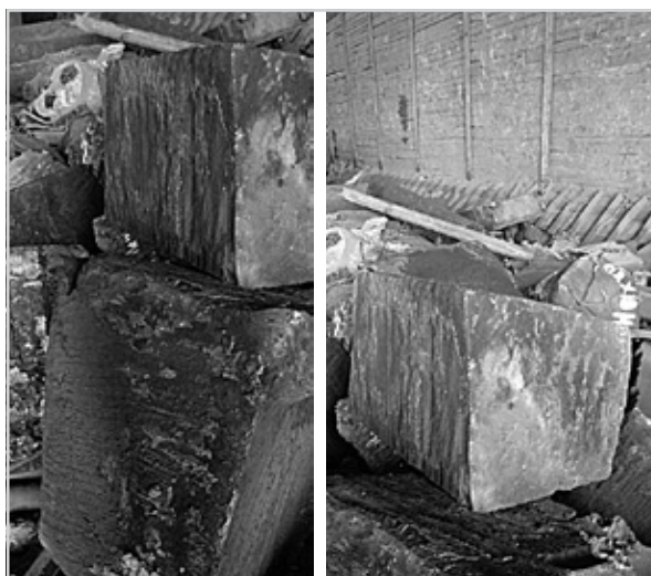
Рис. 8. Поверхность реза. Прибыльная часть слитка из стали 08Х18Н10Т диаметром 1300 мм и высотой 500–600 мм разрезана на четыре части
