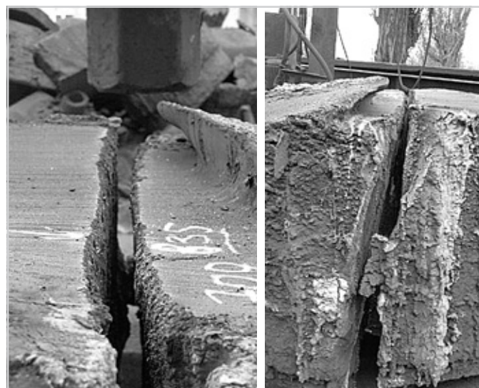
Рис. 7. Полость реза прибыльной части слитка из стали 08Х18Н10Т диаметром 1400 мм и высотой 700 мм
