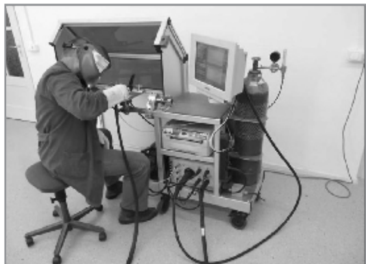
Рис. 3. Полувиртуальная система VWTS с реальной электрической дугой малой мощности
