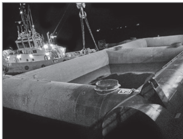
Рис. 4. Отрезанный понтон после подъема на поверхность
