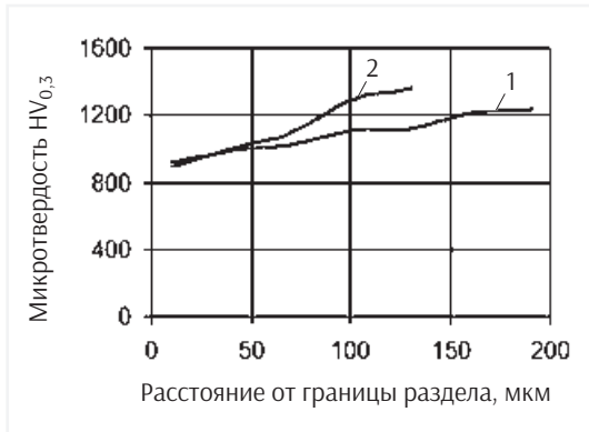
Рис. 6. Изменение микротвердости от границы раздела керамика-основа к поверхности керамического слоя: 1 — первый режим; 2 — второй режим
