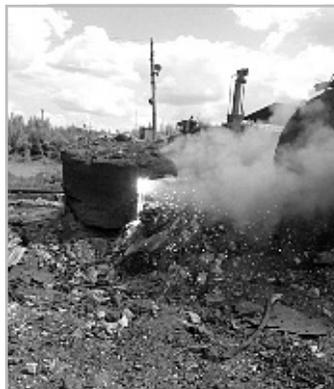
Рис. 2. Процесс кислородной резки чугунного отхода массой 30 т
