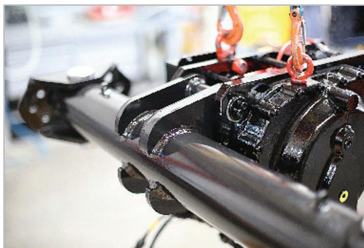
Рис. 3. Аппарат TPS/i, благодаря постоянному и глубокому проплавлению, надежно сваривает швы держателей лебедок, находящиеся под значительной нагрузкой
