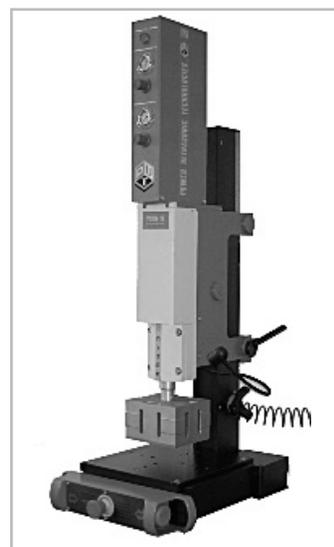
Рис. 2. Установка УЗПК-12 для ультразвуковой сварки пластмасс.
