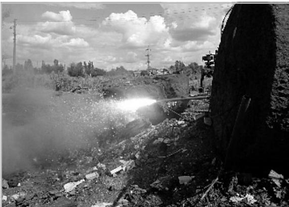
Рис. 1. Врезание кислородной струи в заготовку
