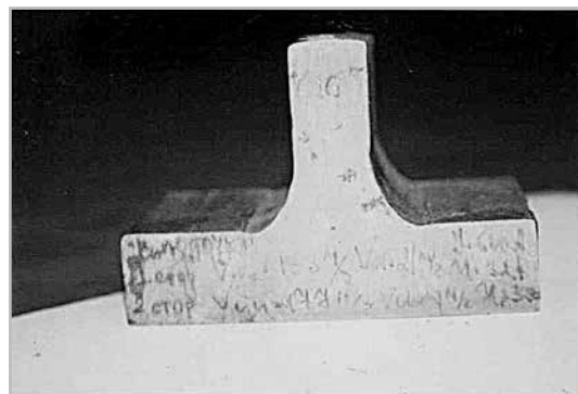
Рис. 4. Макрошлиф сварного соединения выполненного «в лодочку» под флюсом проволокой Ø 4 мм
