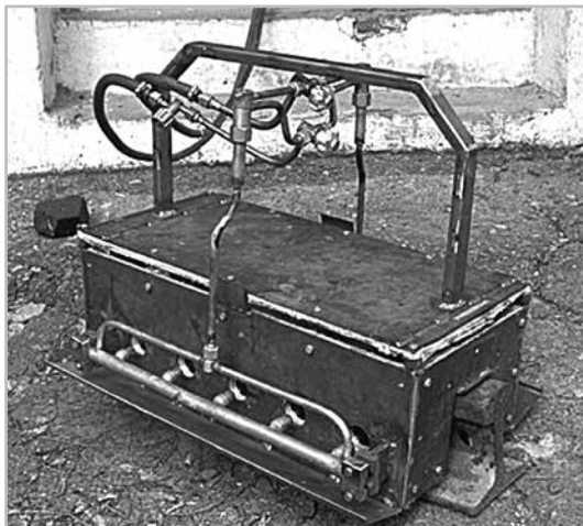
Рис. 6. Испытания переносной установки для нагрева железнодорожных рельсов с термоизоляционным кожухом УНР-ЖД в лабораторных условиях.
