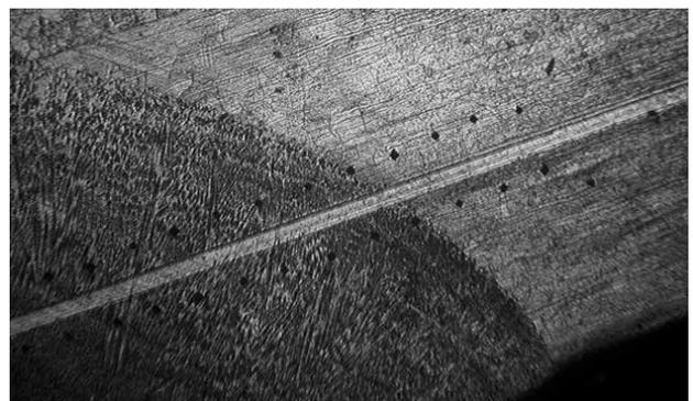
Фото 6. Замер микротвердости в образце
