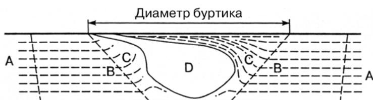
Рис. 17. Схема зон стыкового соединения при СТП
