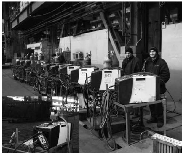
Фото 1. Аппараты для орбитальной сварки фирмы «Polysoude» (Франция)
