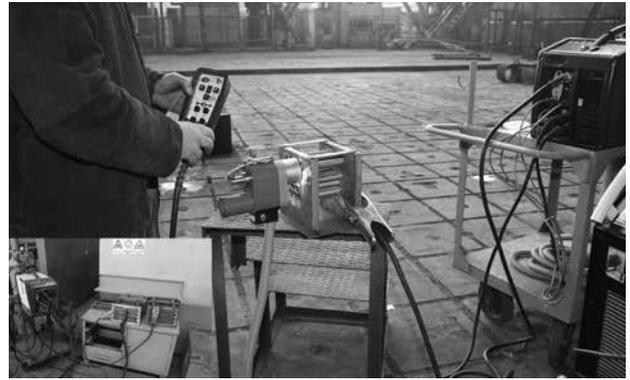
Фото 4. Сварка образцов
