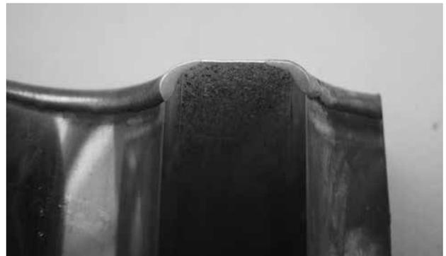
Фото 5. Макроструктура сварного соединения труба — доска наружная
